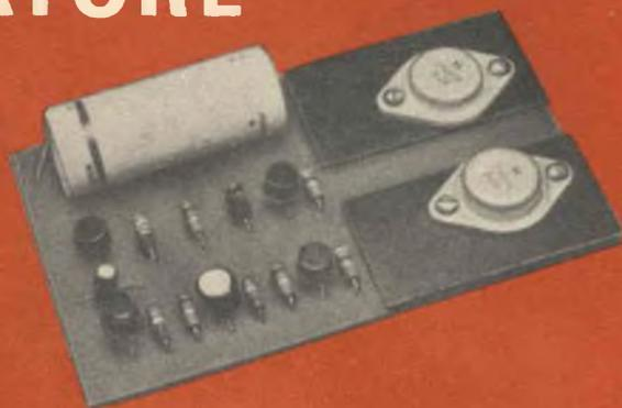
**Questo amplificatore BF con stadio in controfase consente una ampia variazione della tensione di ingresso e dell'impedenza di uscita senza regolazione della tensione di polarizzazione**
