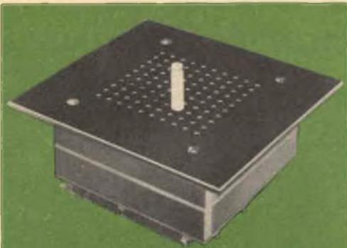
Fig. 13 - Telaio sperimentale a tre strati, molto adatto per il montaggio di circuiti di commutazione e di programmazione.
