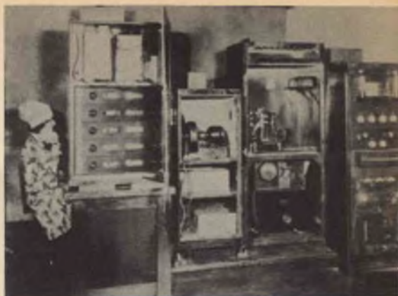
In questa fotografia della Bell Telephone Laboratories si vede una donna ripresa per la televisione nel 1929. A quel tempo l'apparecchiatura per la scansione a colori comprendeva un disco, filtri gelatinosi ed un insieme di fotocellule.
