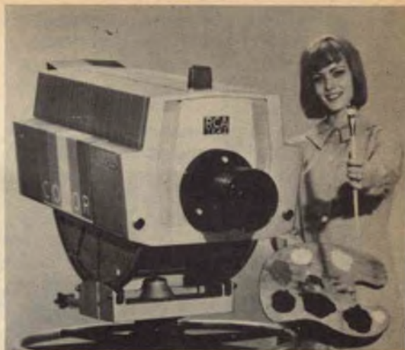
La più recente telecamera a colori della RCA costa circa 44 milioni di lire, è completamente a transistori ed ha 4 tubi di ripresa, uno per ogni colore primario ed uno per l'intensità luminosa.
