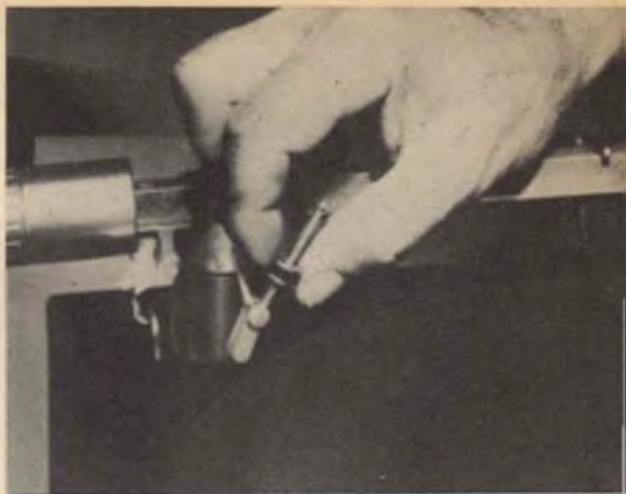
Nella serie di giradischi automatici Lab della Garrard è stato incorporato un contrappeso regolabile per compensare la forza di pattinaggio. Come si vede in questa foto, il pattinaggio è la tendenza del braccio fonografico a spingersi verso il centro del disco; se questo è sprovvisto di solchi che trattengono la puntina. Il braccio pattina.
