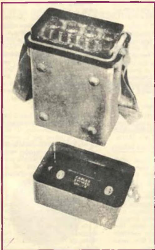
Un dispositivo essiccatore, facilmente accessibile, regola l'umidità interna quando la cassetta è chiusa. Il coperchio è assicurato alla cassetta mediante arresti ad allentamento rapido, e la cassetta a sua volta è fissata allo strumento per mezzo di quattro viti ad incassatura diagonale, situate presso gli orli del pannello anteriore. L'insieme presenta le dimensioni di 25 x 38 x 15 cm e pesa 7 kg.
