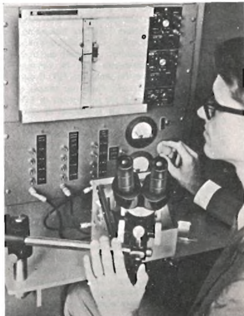
Fig. 1 - L'inventore John A. Copeland, dei Bell Telephone Laboratories, sta usando il nuovo profilometro per tracciare la curva delle densità delle impurità in una basetta semiconduttrice.
