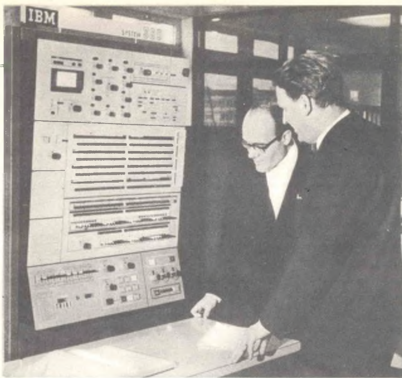
Il Centro di Calcolo dell'Università di Münster fa parte dell'Istituto di Matematica Numerica e Strumentale; dotato di un potente Sistema/360 IBM Modello 50, il centro compie, in particolare, avanzate ricerche nel settore della linguistica per la produzione di testi in Braille.
