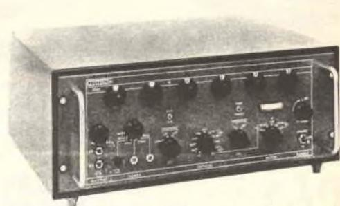
continua, l'onda continua modulata, la modulazione di ampiezza compatibile e la banda laterale unica con completa soppressione di portante o con portante pilota a livelli corrispondenti a  $-16$  dB o  $-26$  dB; è facoltativa la banda laterale autonoma ad uno dei due livelli citati di portante pilota. Su tutti i sistemi impieganti una banda a lato unico, la banda laterale superiore od inferiore è selezionabile mediante un interruttore situato sul pannello frontale.
