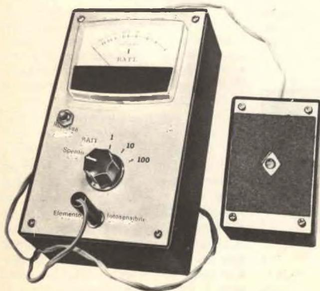
La scatola in cui viene montato il fototransistore Q1 deve essere abbastanza grande per sostenere la macchina fotografica da provare. Il pannello superiore della scatola si ricopre con feltro per evitare scalfitture all'apparecchio.
