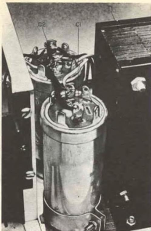
I condensatori di filtro dell'alimentatore, C1 e C2, devono essere montati sul telaio tra l'amplificatore ed il trasformatore d'alimentazione.
