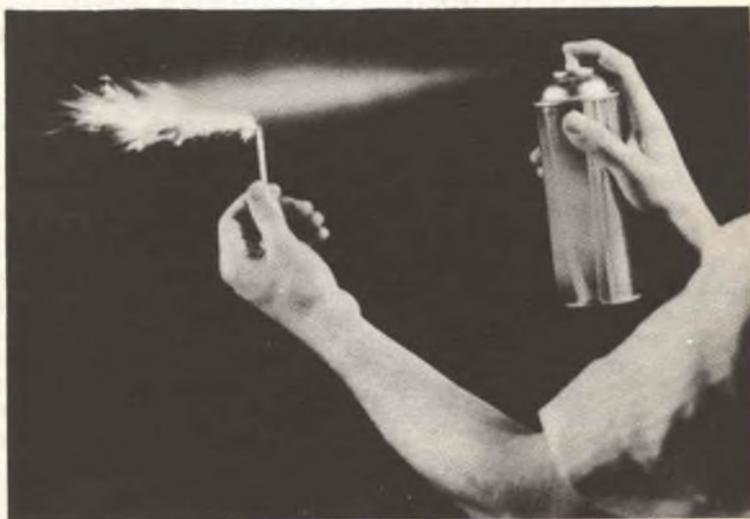
**Questo è esattamente quanto non si deve verificare con un buon pulitore, il quale non deve essere infiammabile. Quantunque spettacolare, una prova simile è relativamente sicura solo se viene effettuata in un ambiente molto aerato.**
