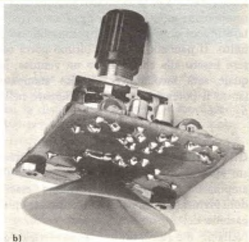
Fig. 7 - In questa figura sono visibili: in a) il preamplificatore con i componenti montati ed in b) il particolare del montaggio della ventosa, che fissa il preamplificatore sulla cassa armonica della chitarra.
