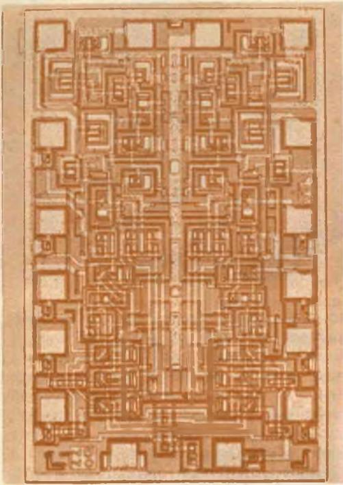
Fig. 6 - Multiplexer digitale a 4 bit MSI della SGS.
