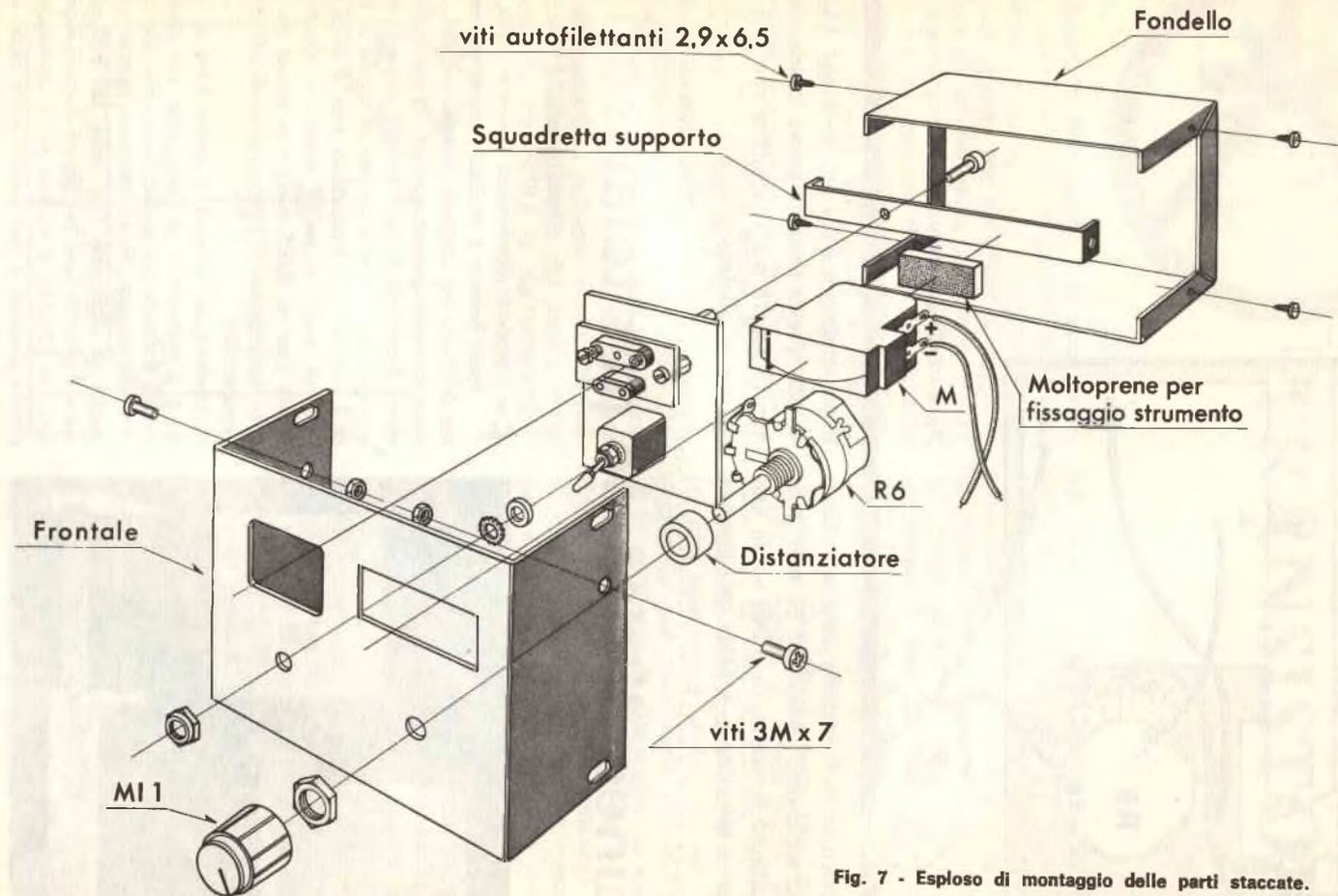
Fig. 7 - Esploso di montaggio delle parti staccate.
