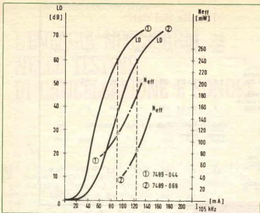
Fig. 3 - Curve di attenuazione di cancellazione (LD) e dell'assorbimento di potenza (N<sub>eff</sub>) in funzione della corrente di AF per f<sub>AF</sub> = 105 kHz (v = 19,05 cm/s; f<sub>NF</sub> = 1 kHz).
