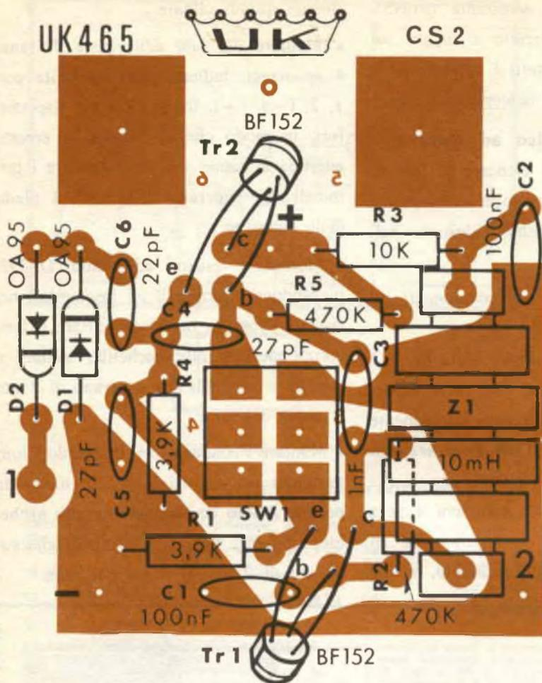
Fig. 3 - Serigrafia del circuito stampato CS2.
