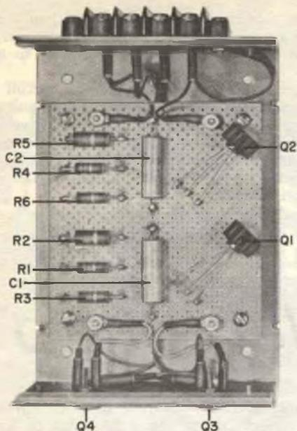
**Per ottenere un insieme robusto, si usi una basetta perforata di vetroresina e grossi connettori ad innesto. I radiatori di calore si avvitano alla basetta.**
