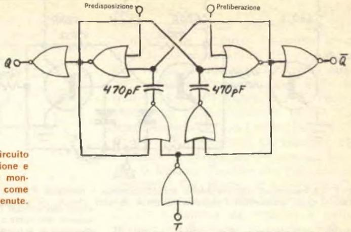
Fig. 9 - Per aggiungere ad un circuito commutato entrate di preliberazione e di predisposizione, è sufficiente montare un flip-flop RS ed usare come entrate le due uscite così ottenute.
