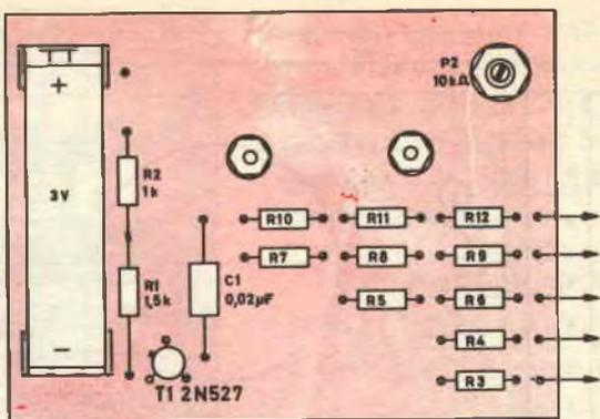
Fig. 2 - Serigrafia del circuito stampato su cui si deve effettuare il montaggio dei vari componenti.
