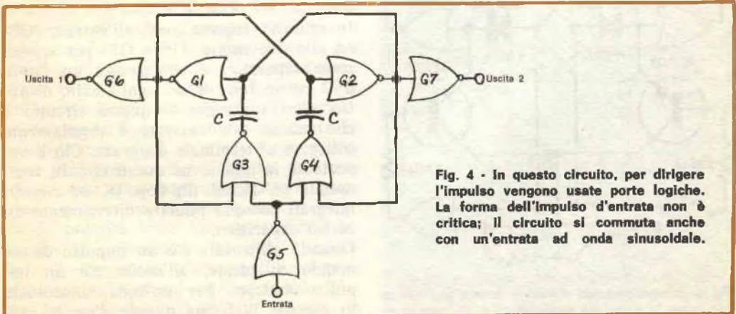
Fig. 4 - In questo circuito, per dirigere l'impulso vengono usate porte logiche. La forma dell'impulso d'entrata non è critica; il circuito si commuta anche con un'entrata ad onda sinusoidale.
