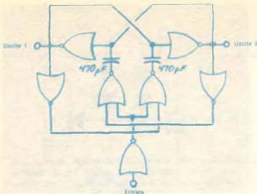
Fig. 5 - Questo schema logico di flip-flop che impiega porte a transistori specifica i valori dei condensatori da usare per entrata ad impulso di comando.
