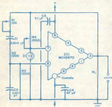
**Fig. 2** - Questo nuovo circuito di potenza, simile ad un oscillatore audio a ponte di Wien, può fornire molto facilmente fino a 300 mA nel carico d'uscita.
