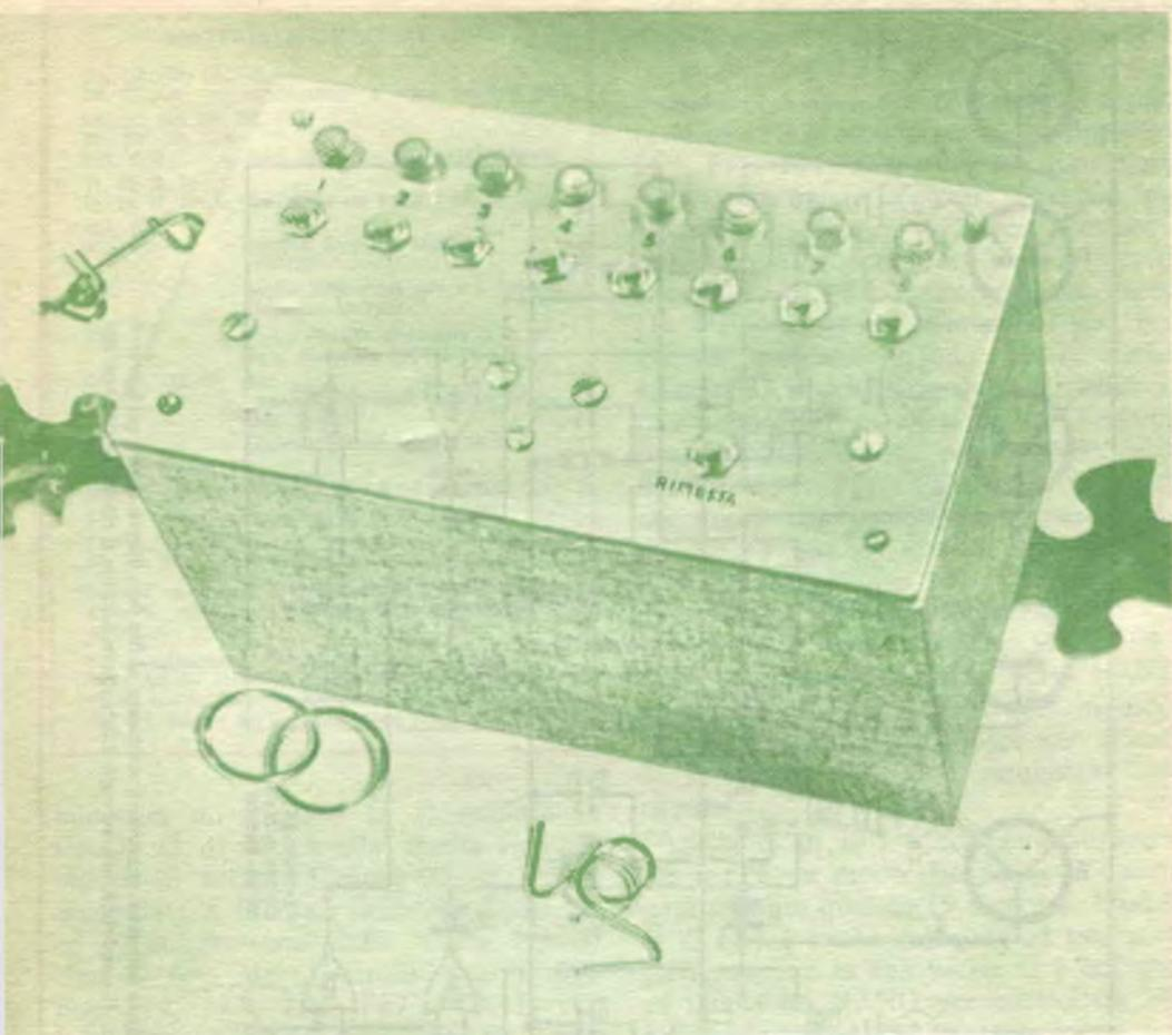
Per evitare di danneggiare i semiconduttori con il calore durante le saldature, si usi un saldatore di bassa potenza e filo di stagno sottile. Le otto lampadine ed i relativi pulsanti e condensatori si montano sul pannello frontale, insieme con il pulsante di rimessa e R11. Montati questi componenti, si può fissare il circuito stampato al pannello frontale, come si vede nelle fotografie.
