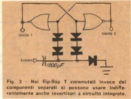
Fig. 3 - Nei flip-flop T commutati invece dei componenti separati si possono usare indifferentemente anche invertitori a circuito integrato.
