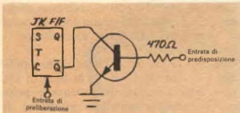
Fig. 11 - Per dotare di un'entrata di predisposizione un flip-flop JK a circuito integrato che non ne sia provvisto, si usi un circuito espansore.
