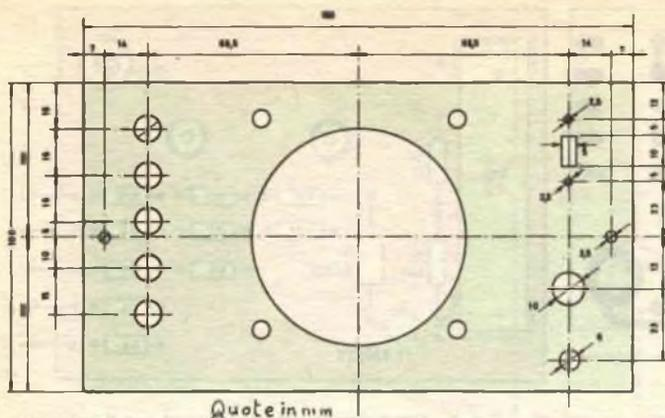
Fig. 5 - Piano di foratura e dati costruttivi del frontale in plexiglass.
