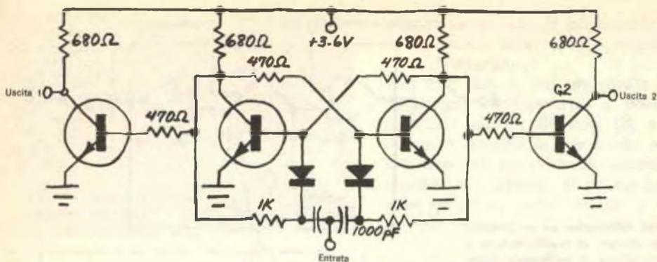
Fig. 7 - I transistori che precedono immediatamente i terminali d'uscita sono separatori, i quali consentono l'aggiunta in serie di altri circuiti ad entrata capacitiva.
