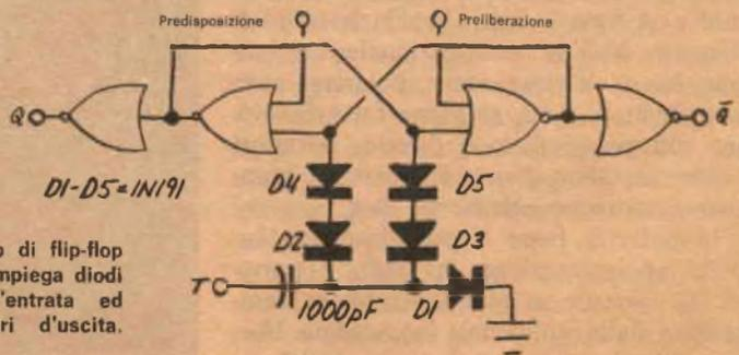
Fig. 10 - Lo schema logico di flip-flop tipo JK qui rappresentato impiega diodi per dirigere l'impulso d'entrata ed invertitori come separatori d'uscita.
