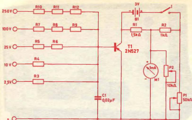
Fig. 1 - Schema elettrico del voltmetro elettronico.
