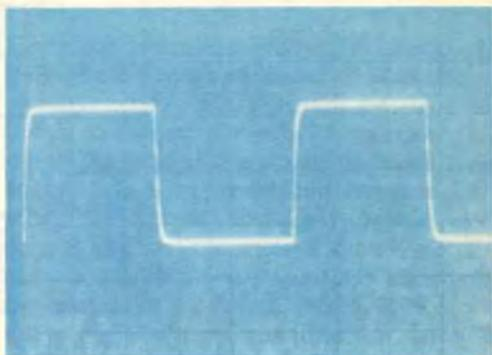
La forma d'onda d'uscita prodotta con un'onda quadra di 10 kHz in entrata non mostra la minima traccia di sovraoscillazioni od altri tipi di instabilità.
