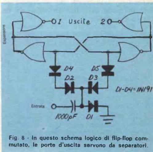
Fig. 8 - In questo schema logico di flip-flop commutato, le porte d'uscita servono da separatori.
