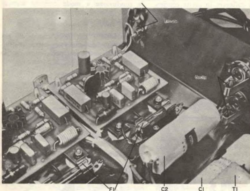
I due canali vengono sorretti da isolatori a colonna di plastica, mentre l'alimentatore è montato sulla base del telaio. Collegamenti ben fatti danno al montaggio un aspetto professionale.
