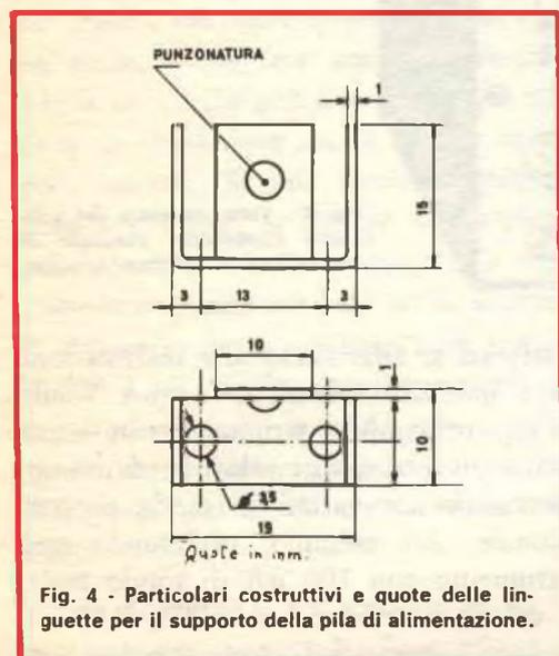
Fig. 4 - Particolari costruttivi e quote delle linguette per il supporto della pila di alimentazione.
