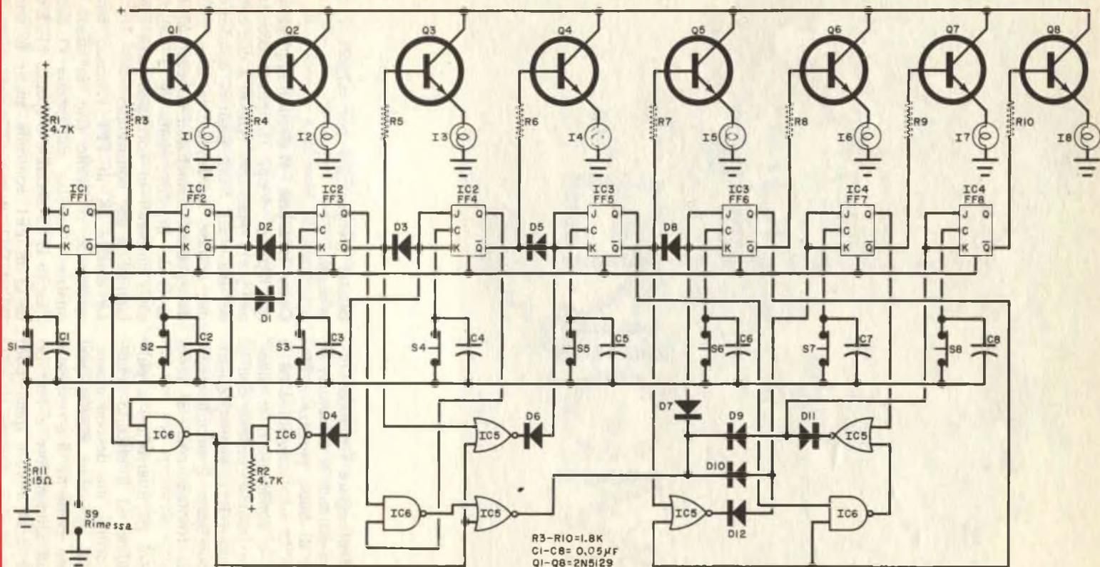
Fig. 1 - Si noti che non vi è un vero e proprio impulso eccitatore applicato ai flip-flop. Basta aprire gli interruttori a pulsante relativi per cambiare stato. Il condensatore su ogni interruttore elimina il rimbalzo dei contatti.
