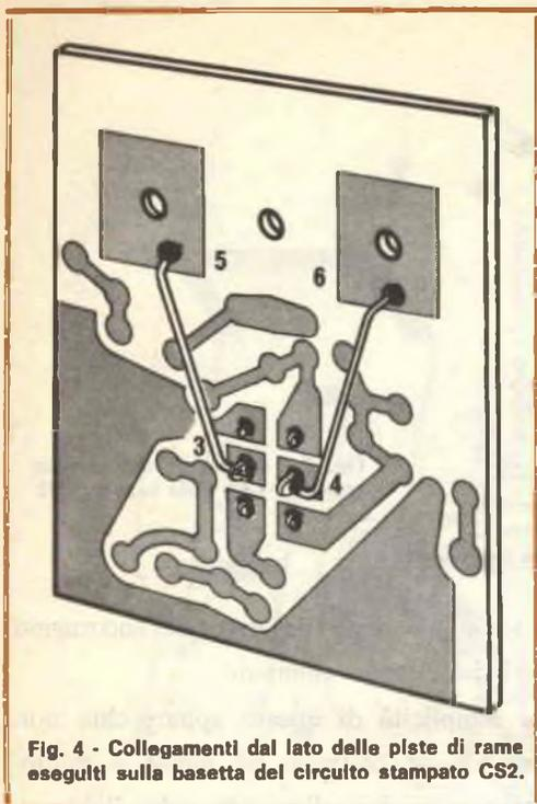
Fig. 4 - Collegamenti dal lato delle piste di rame eseguiti sulla basetta del circuito stampato CS2.
