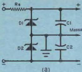
Fig. 3 - Per ottenere una tensione bipolare da un alimentatore singolo, la Motorola consiglia il circuito a), mentre per ottenere un preamplificatore veramente a larga banda per oscilloscopi o strumenti, la Siliconix consiglia il circuito b); questo ha un guadagno di 18 dB con larghezza di banda del valore di 47 MHz.
