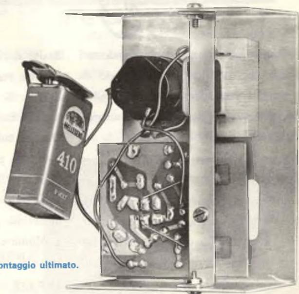
Fig. 2 - Aspetto del prova quarzi a montaggio ultimato.
