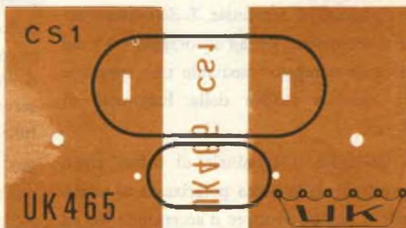
Fig. 5 - Serigrafia del circuito stampato CS1.
