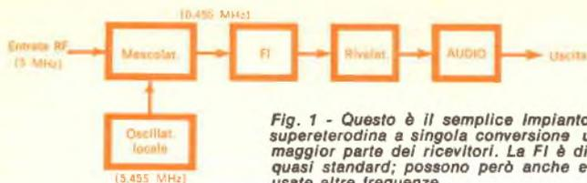
**Fig. 1 -** Questo è il semplice impianto di supereterodina a singola conversione usato nella maggior parte dei ricevitori. La FI è di 455 kHz, quasi standard; possono però anche essere usate altre frequenze.
