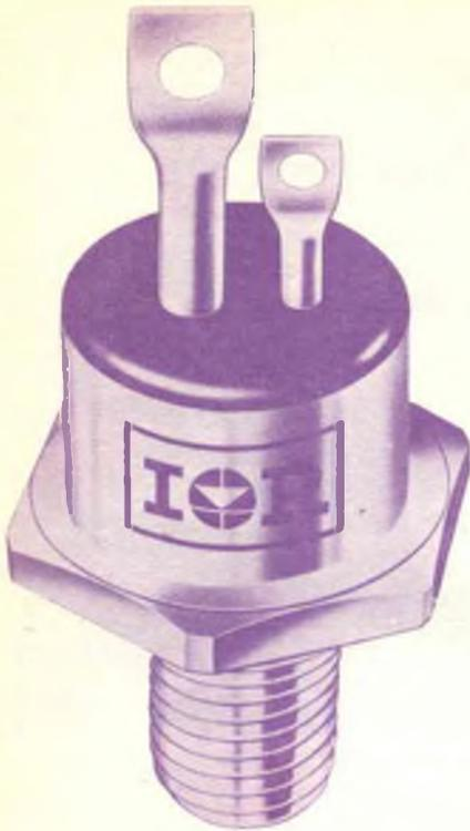
Fig. 4 - Nuovo thyristor di media potenza della International Rectifier.
