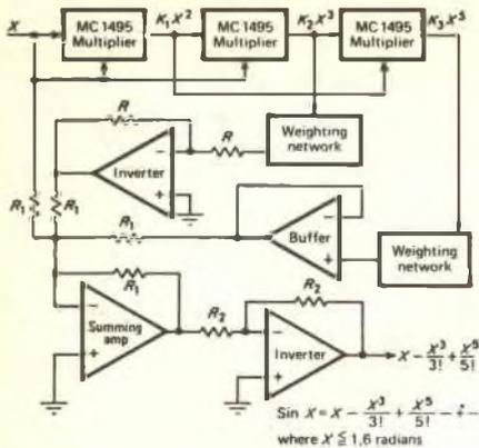
Fig. 9 - Funzioni sinusoidali ottenute con i moltiplicatori.
