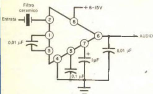
Fig. 9 - Questo stadio FI con IC fornisce un'uscita di 0,8 V con un'entrata bassa fino a 50 µV. Il circuito ha anche una gamma RAS di 60 dB.
