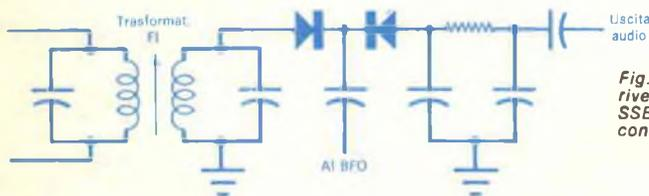
Fig. 11 - Questo semplice rivelatore a prodotto per CW e SSB impiega due diodi contrapposti.
