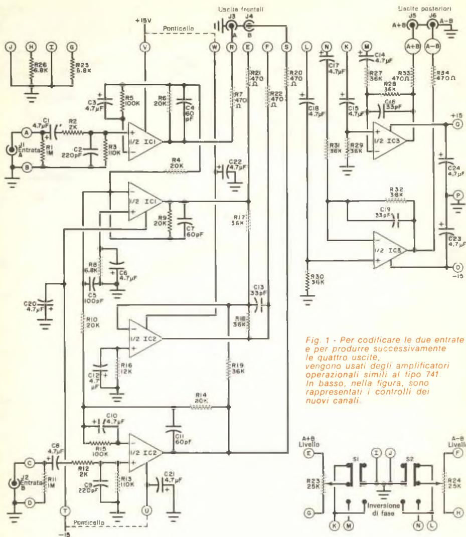
Fig. 1 - Per codificare le due entrate e per produrre successivamente le quattro uscite, vengono usati degli amplificatori operazionali simili al tipo 741. In basso, nella figura, sono rappresentati i controlli dei nuovi canali.
