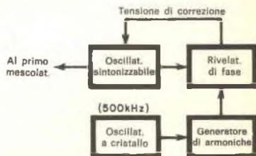
**Fig. 6 -** L'oscillatore sintonizzabile è agganciato all'armonica della frequenza del cristallo e mantenuto in frequenza dall'azione di una rete a blocco di fase.
