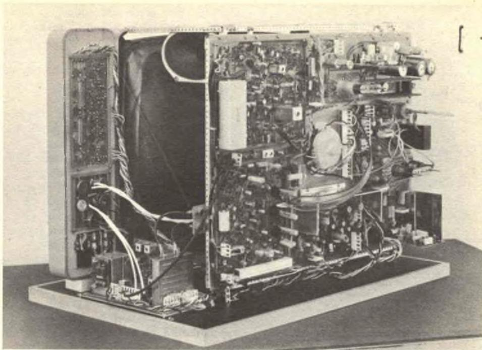
Fig. 3 - Televisione a colori a 110" a static solido realizzato nei laboratori SGS/ATES.
