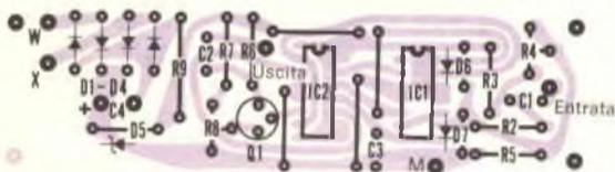
Fig. 2 - Circuito stampato e disposizione dei componenti del prescalatore. Per il montaggio, si usi un saldatore di bassa potenza e filo di stagno sottile.
