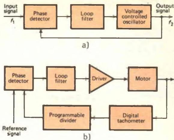
Fig. 12 - Schema a blocchi del circuito fondamentale.
