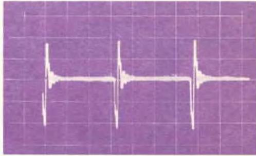
*Corrente primaria nella bobina senza il prolungatore del tempo di pausa (in alto) e con il prolungatore (in basso). La calibratura dell'oscilloscopio è stata fatta per 5 msec per divisione orizzontale e 2,5 A per divisione verticale. Si noti che la corrente circola più a lungo nella bobina usando il prolungatore del tempo di pausa.*
