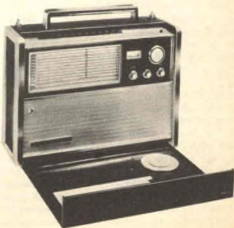
di tasti è posta sulla parte superiore del ricevitore; essi servono a scegliere la gamma e, contemporaneamente, ad accendere e spegnere l'apparato. Ci sono quattro tasti più piccoli per la scelta della larghezza di banda Ma (larga o stretta), per il controllo automatico di frequenza in MF, per la limitazione dei rumori in bassa frequenza (anl) per il comando dell'oscillatore di battimento.
