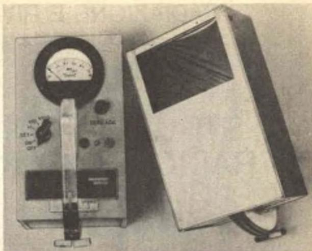
conduttore su entrambi i lati. In alcuni misuratori portatili, sono impiegate sostanze assorbenti sotto forma di piastrelle scorrevoli, di particelle alfa e beta per permettere la misurazione delle particelle beta in presenza di particelle alfa e dei raggi gamma in presenza di particelle beta.
