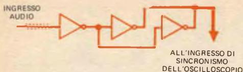
**Fig. 3 - Con tre invertitori CMOS si può comporre un generatore di sincronismo da usare insieme con il dispositivo per la visualizzazione a quattro tracce. Gli invertitori di uscita sono collegati in parallelo.**
