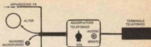
*Fig. 2 - Schema delle connessioni di un accoppiatore telefonico alla stazione CB fissa.*
