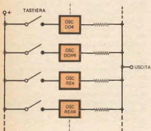
*Fig. 1 - Con un interruttore posto sull'alimentazione di ciascun oscillatore, si ottiene un sistema di struttura semplice e si eliminano i problemi di diafonia, ma si incontrano limitazioni nelle caratteristiche dell'inviluppo ottenibile.*
