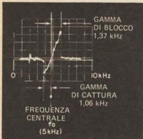
forma di Z, come si vede nella fig. 11. Osservando l'immagine, è possibile misurare e regolare la gamma di blocco e di cattura del circuito e la sua frequenza centrale. Il livello d'entrata deve essere variato perché i parametri possono essere funzioni della tensione d'entrata. Spesso è necessaria una bassa frequenza di sweep perché alcuni circuiti PLL, per ridurre il rumore, hanno un responso lento.
