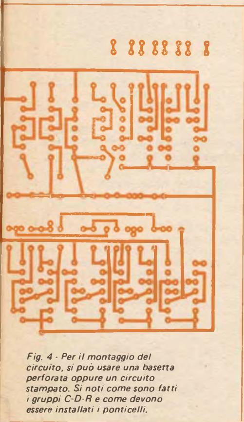
*Fig. 4 - Per il montaggio del circuito, si può usare una basetta perforata oppure un circuito stampato. Si noti come sono fatti i gruppi C-D-R e come devono essere installati i ponticelli.*
