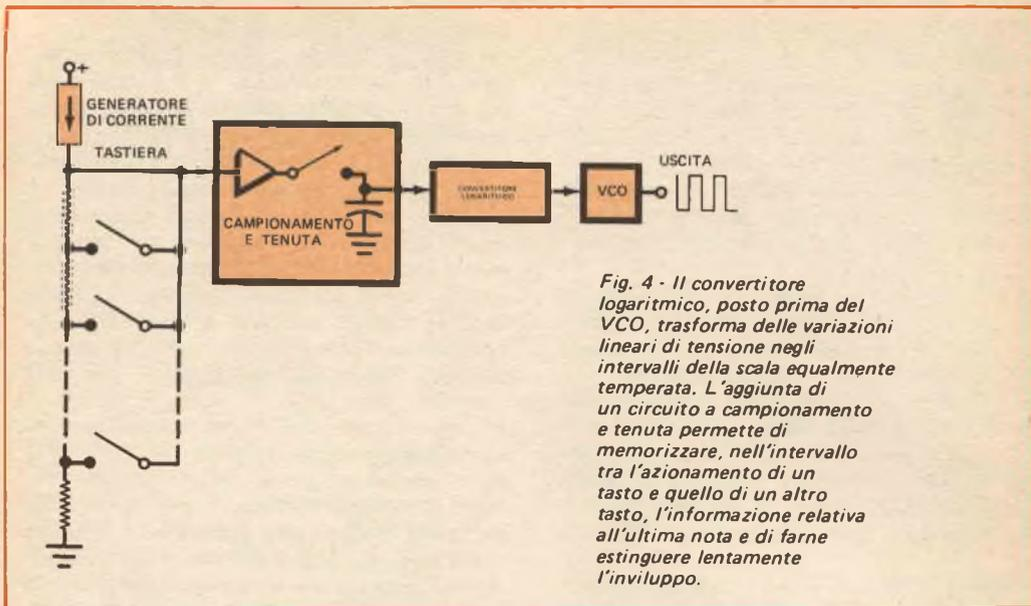
*Fig. 4 - Il convertitore logaritmico, posto prima del VCO, trasforma delle variazioni lineari di tensione negli intervalli della scala egualmente temperata. L'aggiunta di un circuito a campionamento e tenuta permette di memorizzare, nell'intervallo tra l'azionamento di un tasto e quello di un altro tasto, l'informazione relativa all'ultima nota e di farne estinguere lentamente l'involuppo.*
