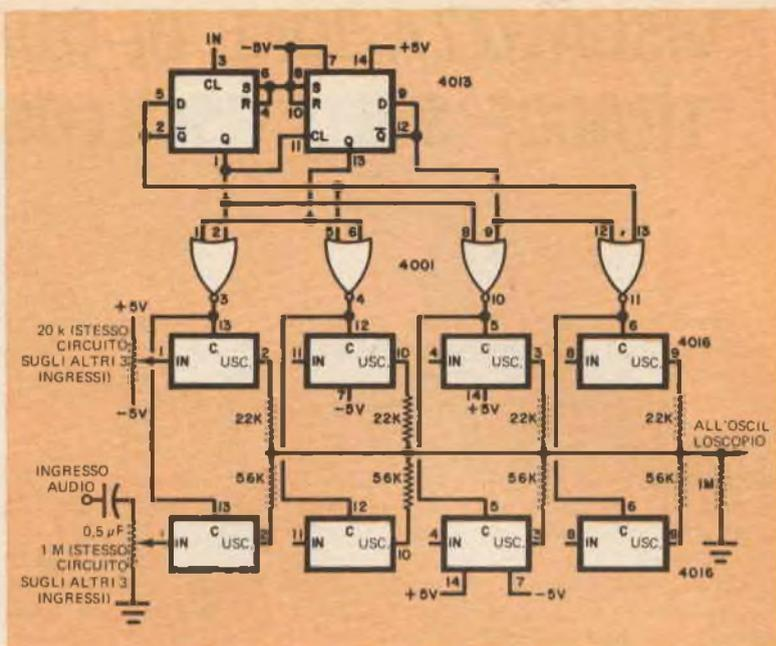
Fig. 2 - Per ottenere una rapida scansione delle tracce, si può usare l'oscillatore a CMOS rappresentato in a). Il circuito rappresentato in b), più semplice, serve per la scansione al ritmo di una traccia ogni spazzolata orizzontale.
