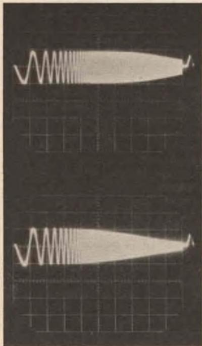
*Fig. 6 - Responso di un amplificatore da 1 kHz a 100 kHz con livello di 1 W (in alto) e con livello di 15 W (in basso). Si noti come il responso vari con la potenza e come il punto a 3 dB si abbassi un poco di frequenza.*
