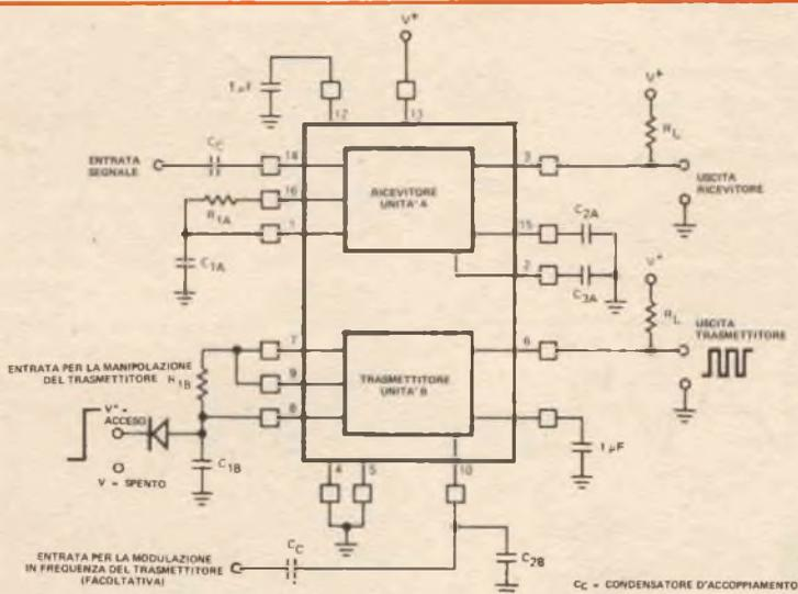
*Fig. 2 - Due applicazioni del decodificatore doppio di nota XR-2567. Nel ricetrasmittitore di nota, illustrato nel particolare a), l'unità A serve come ricevitore di nota e l'unità B come trasmettitore di nota. Nel particolare b), a destra, viene usata solo metà del circuito integrato come oscillatore di precisione da impiegarsi in circuiti come generatori di nota per strumenti musicali.*
