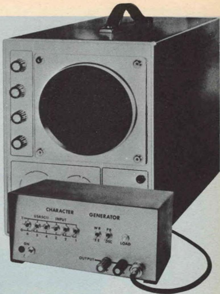
ed il punto di scansione viene rapidamente deflesso oltre la parte superiore dello schermo. Le risultanti tracce verticali hanno una luminosità molto scarsa e non disturbano il carattere che viene formato. Una memoria interna, che impiega un codice computer normale, immagazzina le forme dei caratteri e la linea delle lettere e dei numeri scelti.
