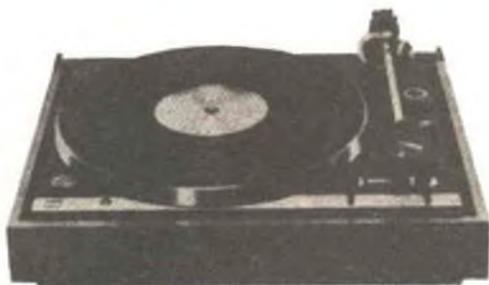
Il giradischi automatico senza cambiadischi Mod. 701 della Dual è dotato di un sistema a trazione diretta con regolazione automatica. Il suo motore, che gira ad una velocità di  $33\frac{1}{3}$  (o, a scelta, 45) giri al minuto, elimina la necessità di rotelle o cinghie di trasmissione; grazie alla bassissima velocità di rotazione, il rumore di fondo risulta minimo e con frequenza al di sotto del campo di udibilità.
