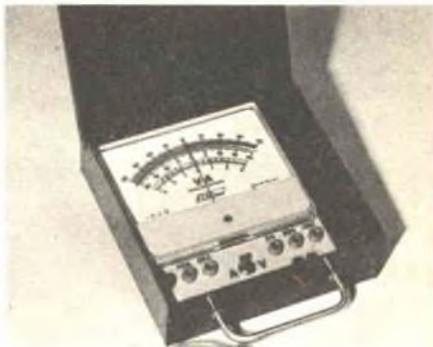
strumento tipico a cui l'eletttrauto ricorre ogniqualvolta si debba ricercare un guasto e controllare i circuiti elettrici di un autoveicolo.
