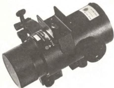
La divisione Componenti della ITT ha presentato sul mercato una torcia laser all'infrarosso, il tipo RT 4 A. Si tratta di una torcia maneggevole, funzionante a batteria e munita di un diodo laser semiconduttore pilotato a impulsi, che genera una radiazione infrarossa con una lunghezza d'onda di 850 mm.
