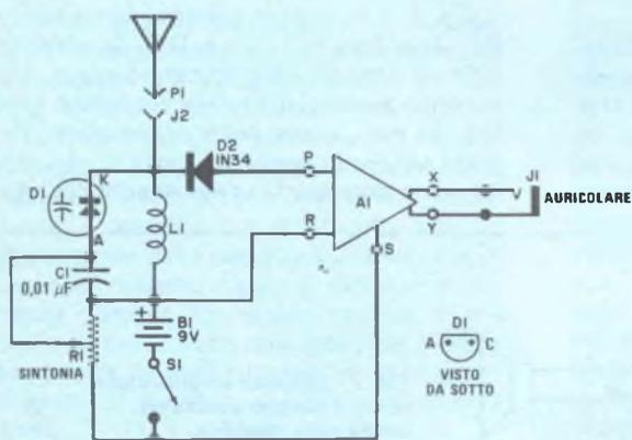
Fig. 2 - Schema dell'amplificatore modificato con l'aggiunta di alcuni componenti per farne un ricevitore per aereeolinee.
