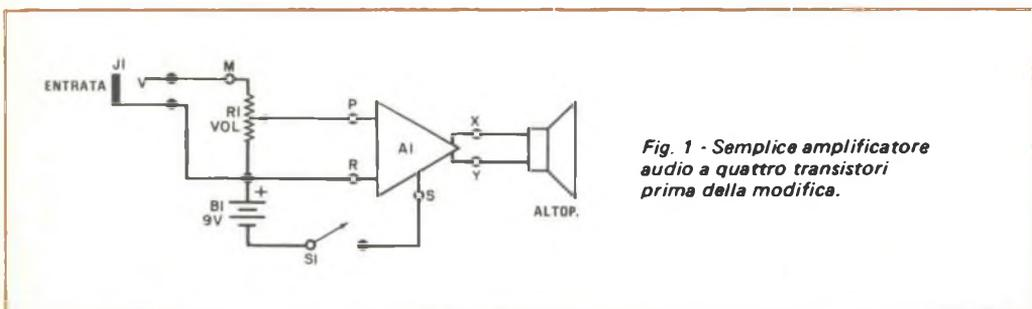
*Fig. 1 - Semplice amplificatore audio a quattro transistori prima della modifica.*
