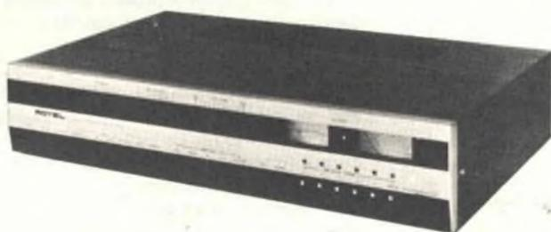
grato. Il ricevitore infatti viene sintonizzato elettronicamente grazie ai varactor (diodi la cui capacità viene controllata per mezzo di una tensione continua ad essi applicata). La "scala" di sintonia è in realtà un voltmetro c.c. che indica la tensione; è calibrato in megahertz (MHz) per la MF e in kilohertz (kHz) per la MA. Vicino a questo strumento ve ne è un altro, di uguale grandezza, che indica la sintonia a centro canale per la MF e l'intensità relativa del segnale per la MA.
