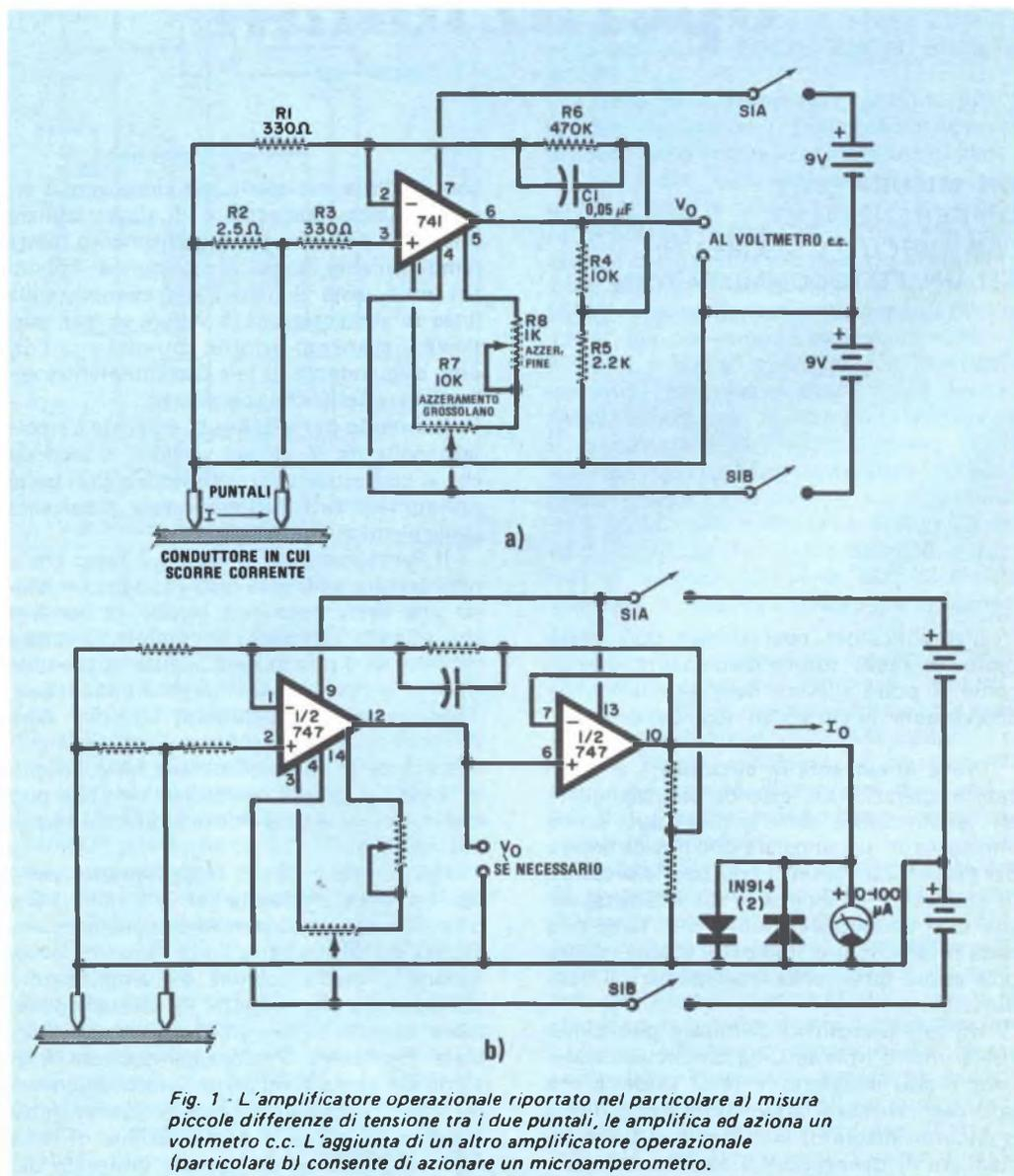
Fig. 1 - L'amplificatore operazionale riportato nel particolare a) misura piccole differenze di tensione tra i due puntali, le amplifica ed aziona un voltmetro c.c. L'aggiunta di un altro amplificatore operazionale (particolare b) consente di azionare un microamperometro.
