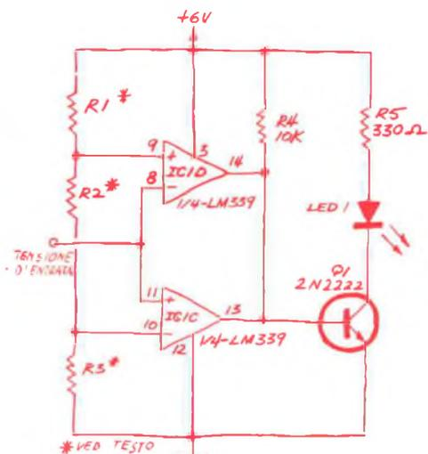
Fig. 4 - Comparatore di limite con LM339.
