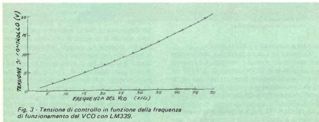
Fig. 3 - Tensione di controllo in funzione della frequenza di funzionamento del VCO con LM339.
