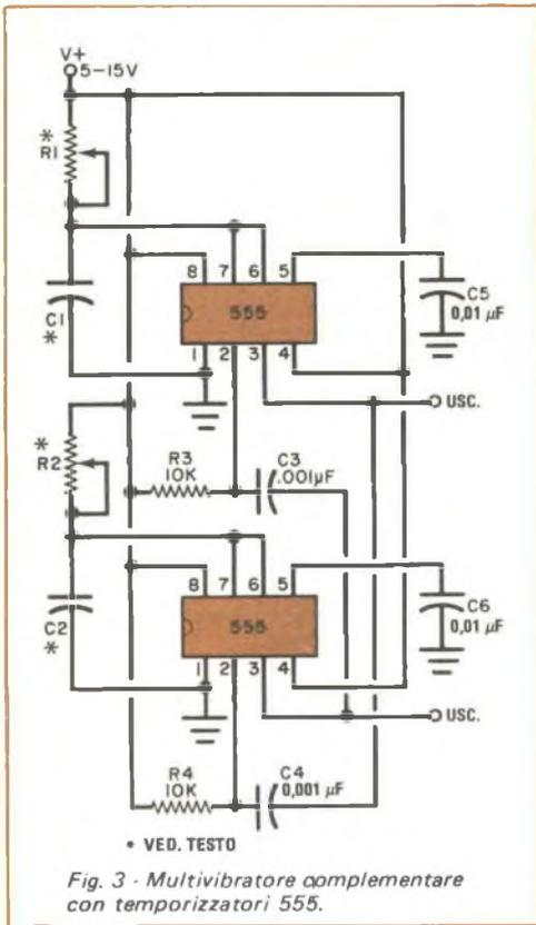
Fig. 3 - Multivibratore complementare con temporizzatori 555.
