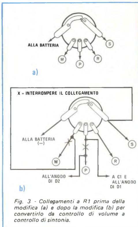
Fig. 3 - Collegamenti a R1 prima della modifica (a) e dopo la modifica (b) per convertirlo da controllo di volume a controllo di sintonia.
