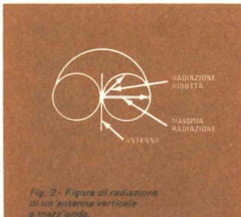
Fig. 2 - Figura di radiazione di un'antenna verticale a mezz'onda.
