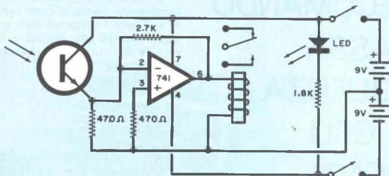
*Fig. 2 - Un fototransistore e un amplificatore operazionale sono uniti per formare un sistema pilota di relé fotosensibile che può essere attivato mediante una torcia elettrica attraverso un locale.*
