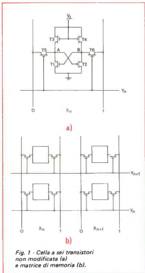
Fig. 1 - Cella a sei transistori non modificata (a) e matrice di memoria (b).
