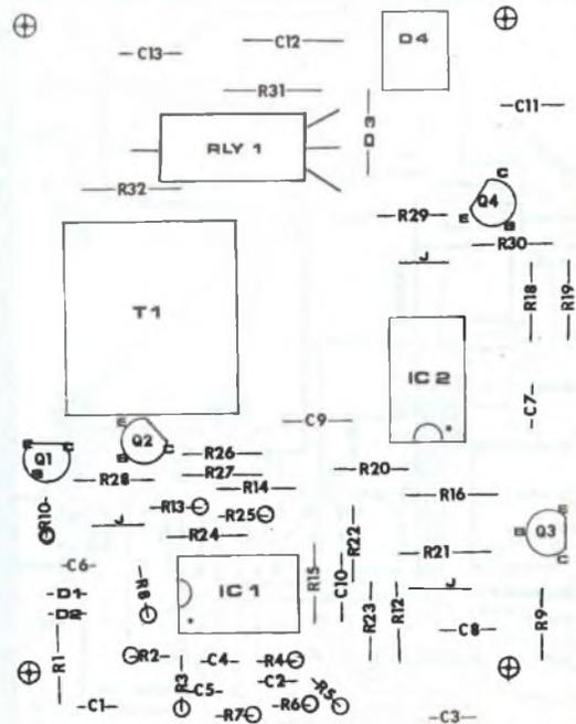
Il relé a bacchetta K1 è necessario per il completo isolamento tra il circuito ed il triac. Il circuito di arresto C12 e R32 protegge Q5 dai transienti e dalle sovratensioni di rete generati quando carichi induttivi (come trasformatori di alimentazione in amplificatori di alta potenza) vengono spenti improvvisamente. Il triac deve essere provvisto di dissipatore di calore.
