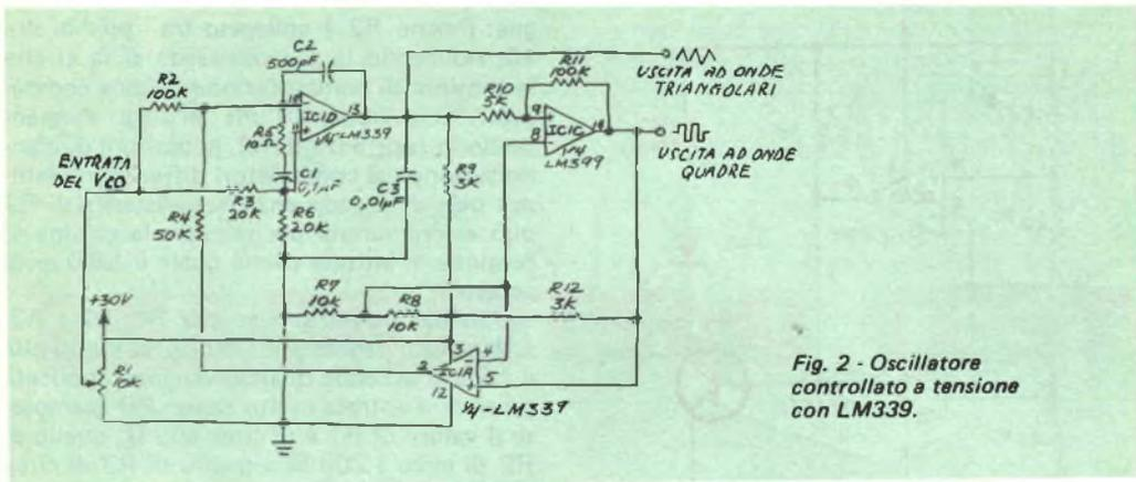
Fig. 2 - Oscillatore controllato a tensione con LM339.
