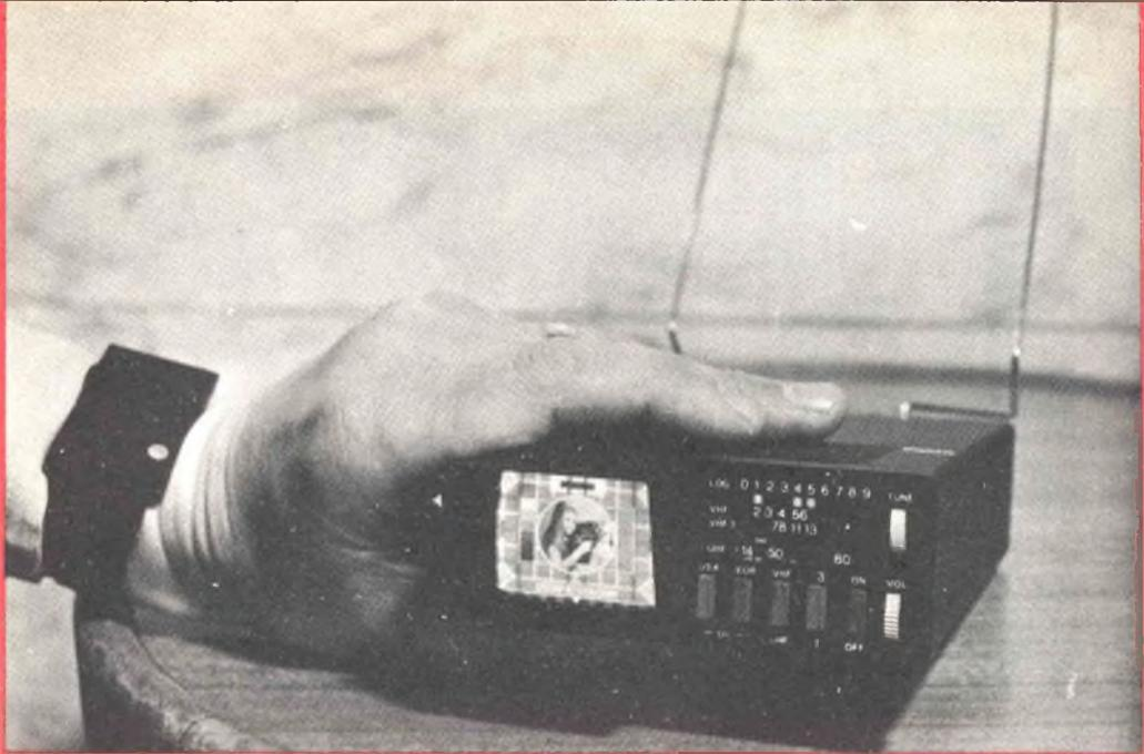
La compagnia britannica Sinclair Radionics Limited, dopo dodici anni di ricerche, ha immesso sul mercato un apparecchio televisivo con uno schermo di soli due pollici (50,8 mm). Il televisore può essere alimentato sia da quattro batterie ricaricabili, che permettono quattro ore di funzionamento, sia direttamente dalla rete elettrica. Le sue dimensioni d'ingombro sono minime; misura infatti 101,6 mm di larghezza, 152,4 mm di lunghezza, 38 mm di profondità e pesa solo
