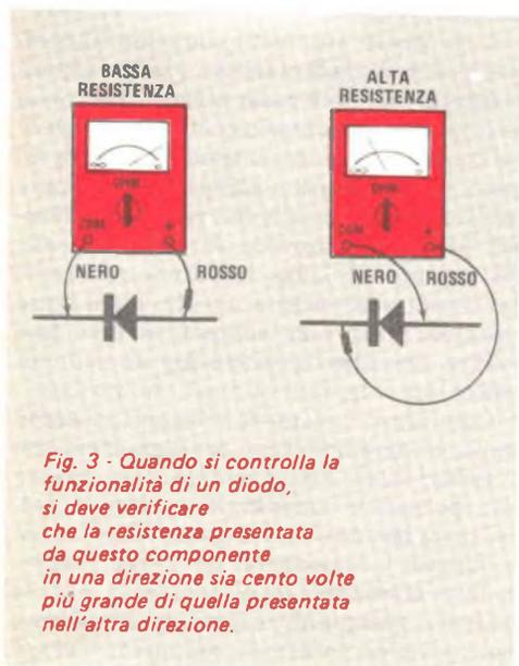
*Fig. 3 - Quando si controlla la funzionalità di un diodo, si deve verificare che la resistenza presentata da questo componente in una direzione sia cento volte piú grande di quella presentata nell'altra direzione.*
