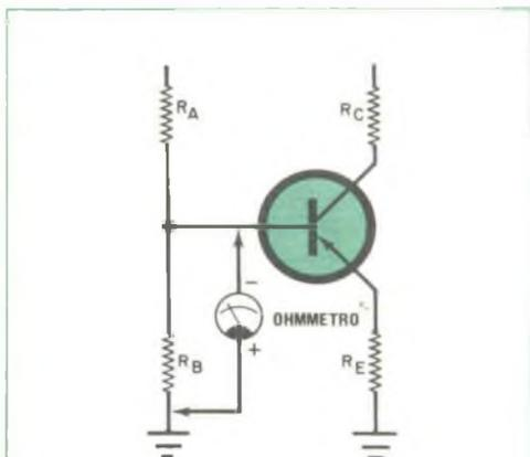
Fig. 4 - Questa disposizione può provocare un errore nella misura della resistenza del resistore di base.
