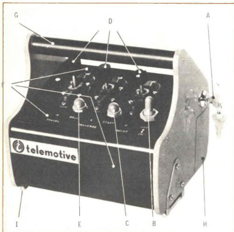
*Fig. 2 - Tipica trasmittente Telemotive; essa è dotata di: interruttore di bloccaggio (A), comando principale inserito/disinserito (B), avviamento di sicurezza (C), interruttori a più posizioni (D), interruttore campanello (E), dati su richiesta del committente (F), maniglia di protezione (G), scomparto batterie (H), guida cinghia (I).*
