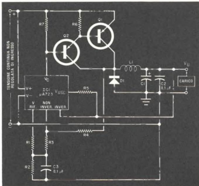
Fig. 2 - Schema elettrico di un regolatore a commutazione più sofisticato, che impiega l'integrato 723 come amplificatore d'errore.
