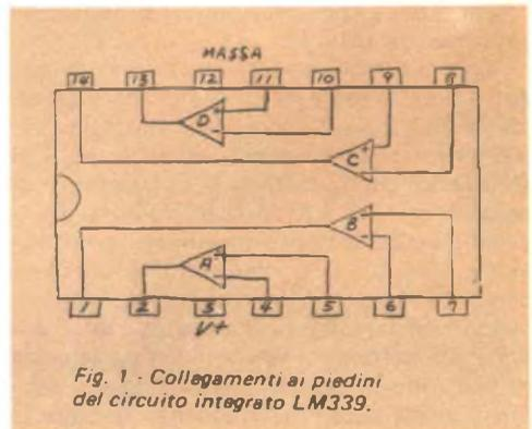
*Fig. 1 - Collegamenti ai piedini del circuito integrato LM339.*
