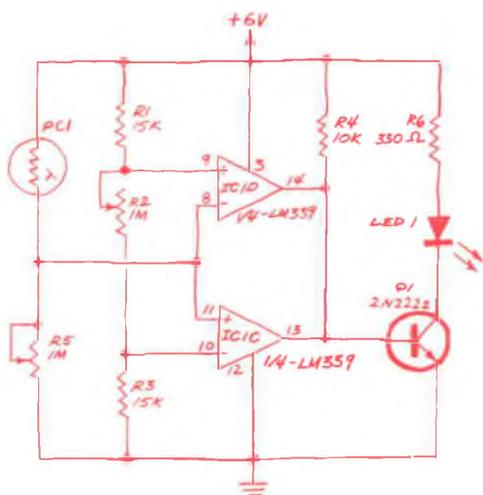
Fig. 5 - Comparatore di limite che funziona come fotometro programmabile.
