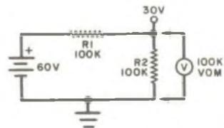
Fig. 1 - Il tester raffigurato in questa situazione carica il circuito provocando un errore di misura del 33,3%.
