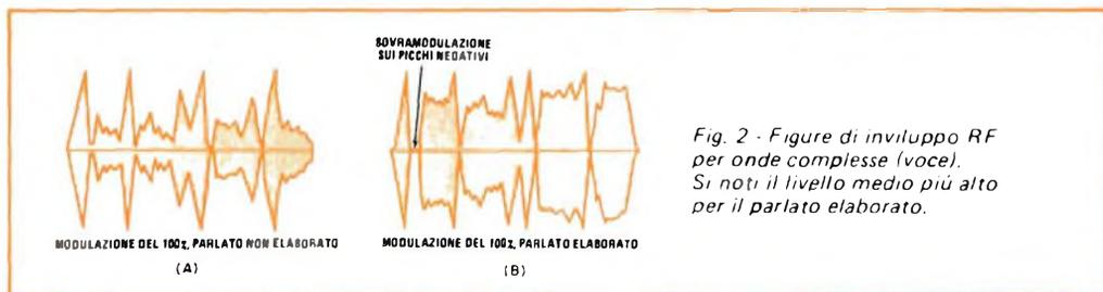
Fig. 2 - Figure di inviluppo RF per onde complesse (voce). Si noti il livello medio più alto per il parlato elaborato.
