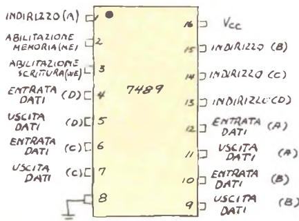
Fig. 1 - Collegamenti ai piedini della RAM 7489.
