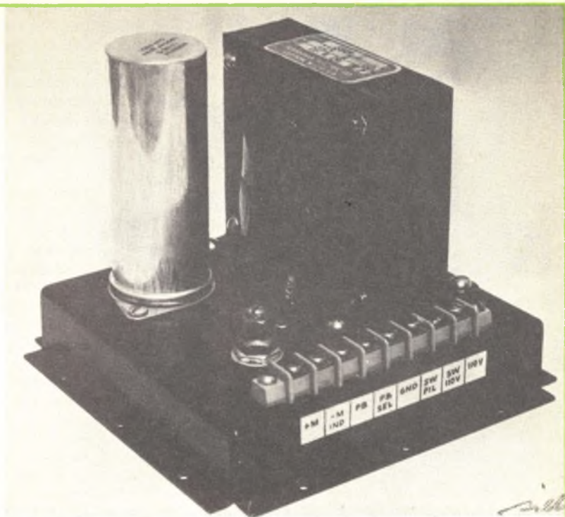
Fig. 3 - In questa figura è visibile la seconda parte del commutatore a distanza, cioè l'alimentatore.
