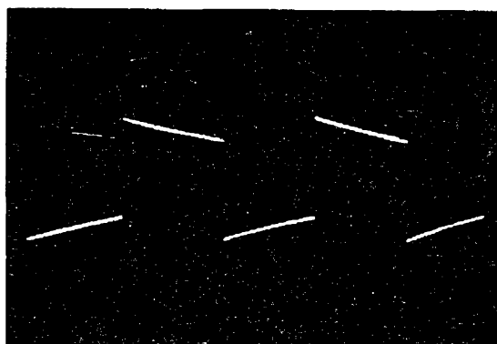
Obr. 83. Oscilogram odezvy (tj. výstupního signálu) zesilovače zkoušeného napětím obdélníkového průběhu s poklesem nízkých kmitočtů proti opakovacímu f_0
