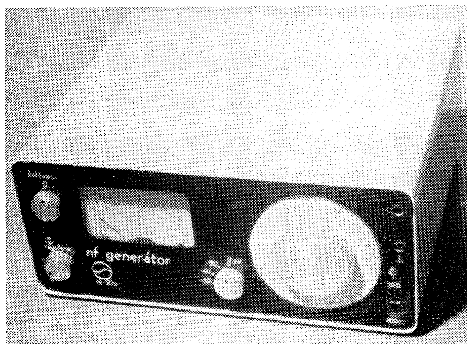
Obr. 41. Zázneřový nf generátor s širo- kopásmovým výko- novým zesilovačem, zasunutý do skříňky z duralového plechu
