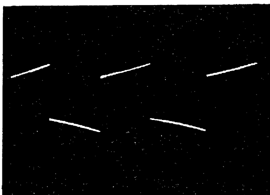
Obr. 85. Oscilogram výstupního signálu zesilovače, vyjadřující zdůraznění nízkých kmitočtů
