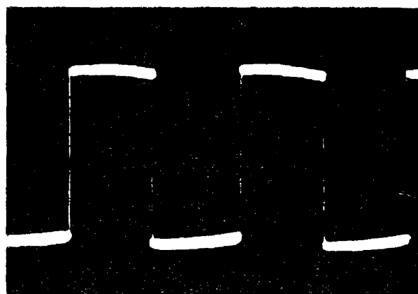
Obr. 65. Oscilogram výstupního napětí zesilovače, buzeného signálem obdélníkového průběhu s opakovacím kmitočtem 30 Hz. Bez zakmitávání, s malým poklesem zesílení nízkých kmitočtů proti základnímu kmitočtu 30 Hz
