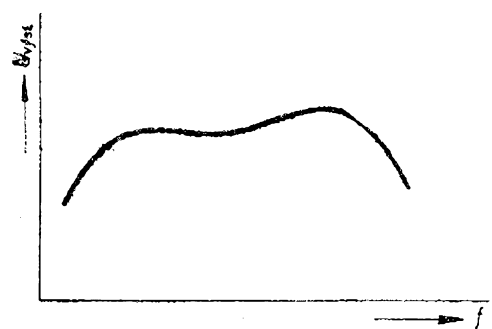
Obr. 14. Standardní průběh kmitočtové charakteristiky magnetofonů
