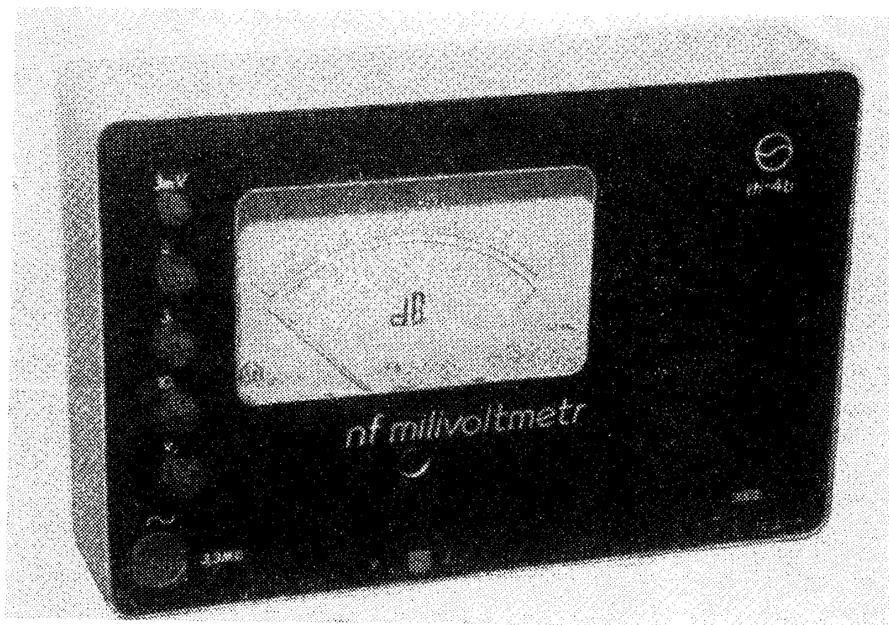
Obr. 50. Sestavený a dohotovený nf milivoltmetr v ochranné kovové skříni
