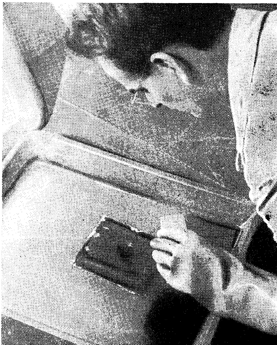
Obr. 65. Odleptávání měděné fólie
