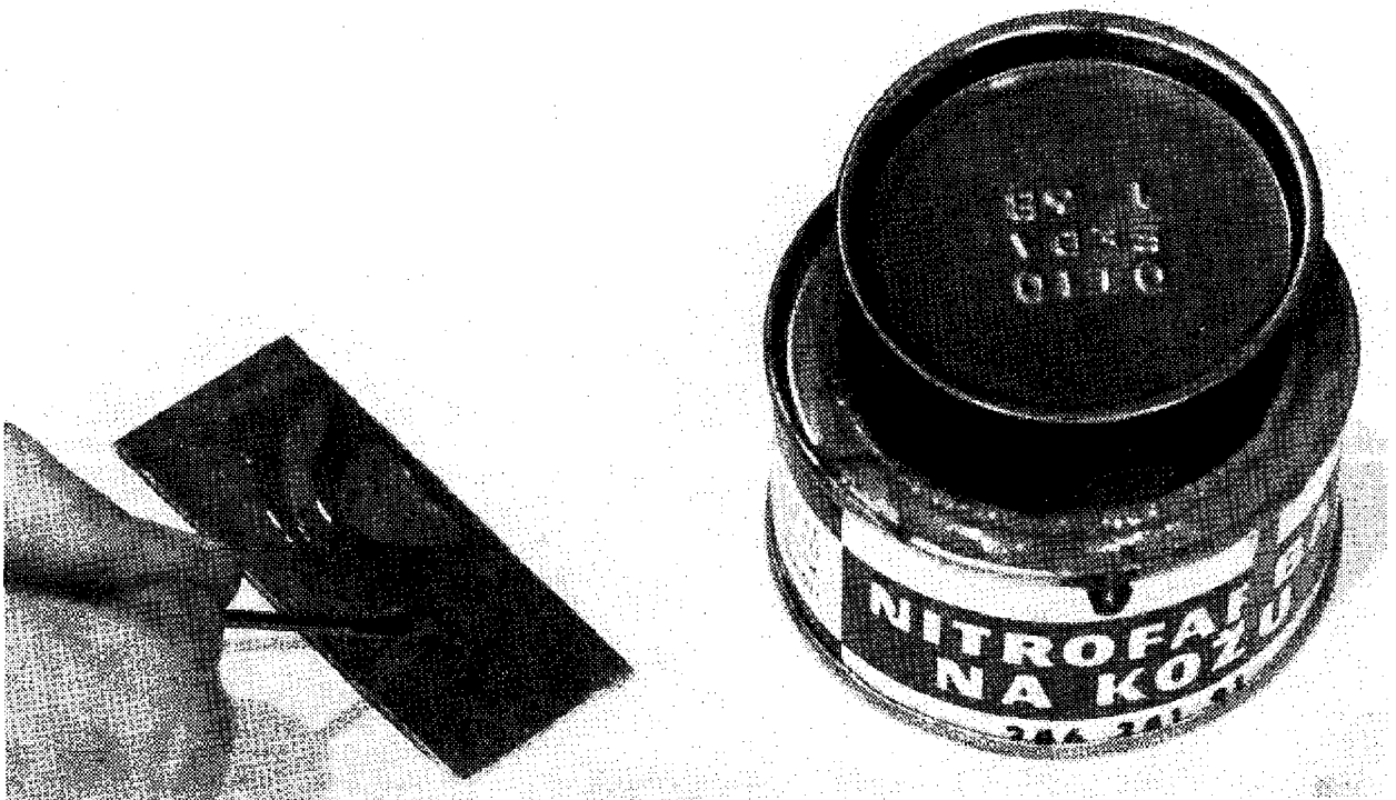
Obr. 73. Kreslení obrazce plošných spojů na cuprexitovou destičku acetonovou barvou
