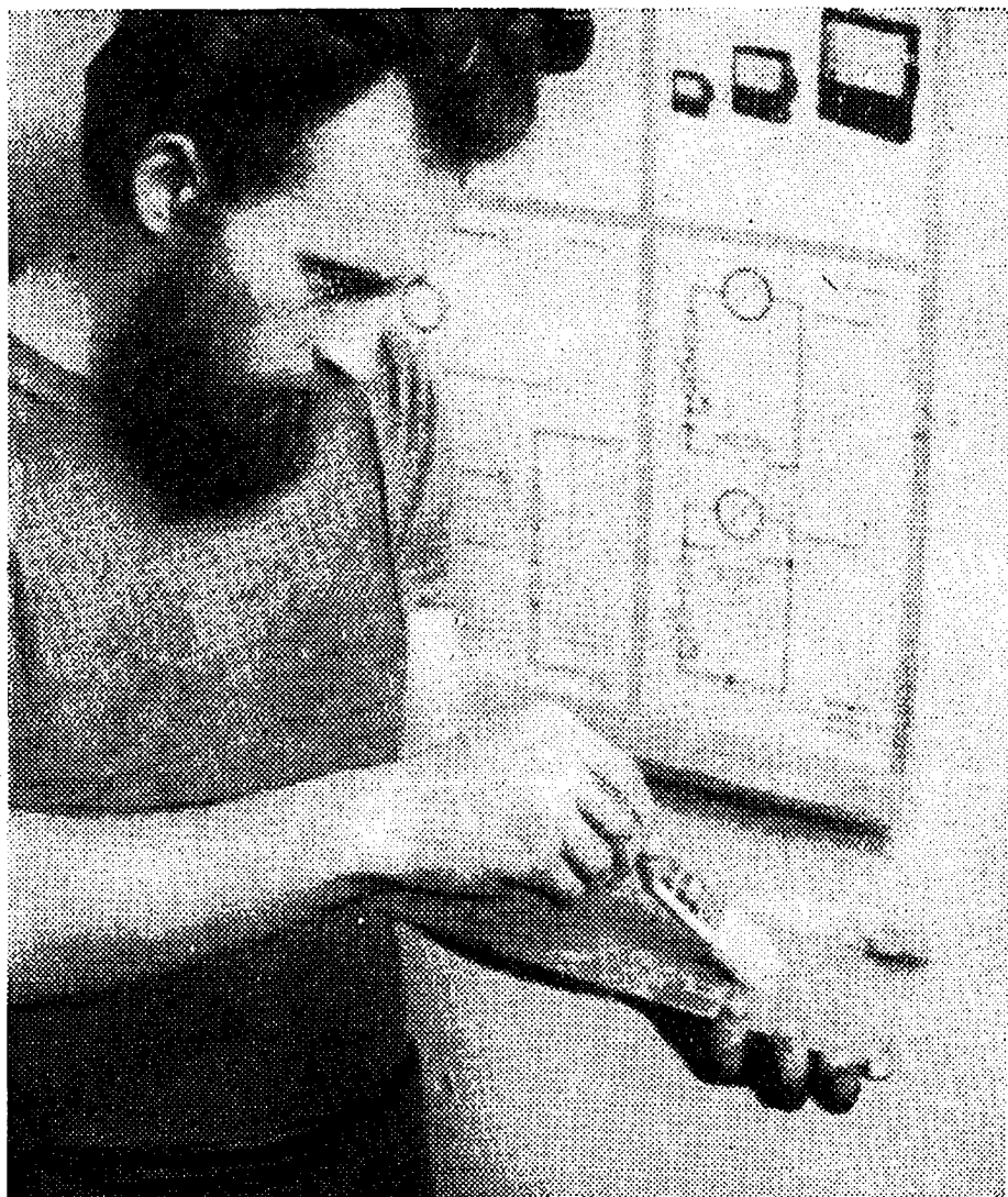
Obr. 71. Lakování hotových destiček s plošnými spoji
