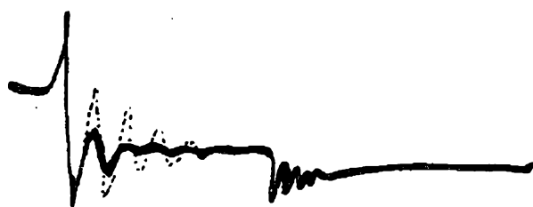
Obr. 61. Jiný oscilogram při vadné zapalovací cívice
