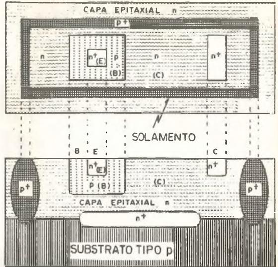
Fig. 11 - Transistor bipolar integrado NPN visto de cima e em corte.
