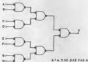
Figura 1: Diagrama do estado lógico da função X que substitui, na técnica digital, a função das quatro chaves do "Cadeado Eletrônico".
