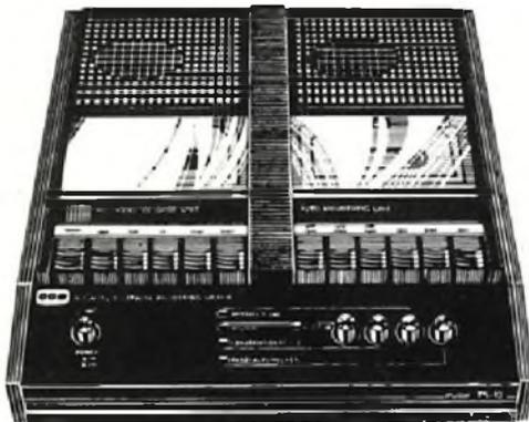
Atende e fornece recados automaticamente; grava conversas telefônicas; possibilita a retransmissão de recados para a linha telefônica; funciona como gravador cassette convencional; possibilita a monitoração da linha; microfone embutido; tomada para microfone externo; saída para fone de ouvido; entrada auxiliar.
