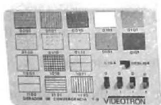
Possibilita os seguintes ajustes em televisores em cores e preto e branco: convergência estática, convergência dinâmica, linearidades horizontal e vertical, centralização do quadro, ajuste de branco e ajuste de pureza.
