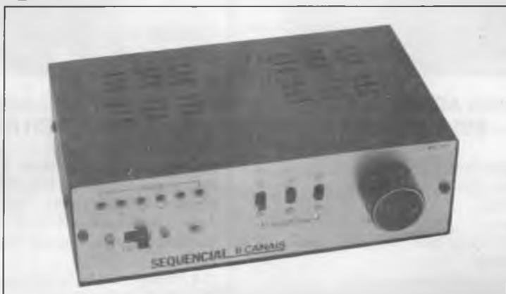
*Os seis triacs de 8 ampères deste sistema sequencial de 6 canais permitem o controle de até 880 watts de lâmpadas, por canal, na rede de 110V e de até 1760 watts de lâmpadas, por canal, na rede de 220V. É claro que o leitor não vai precisar de tudo isso de carga para alimentar um sistema de decoração de vitrine ou mesmo um salão de baile, mas certamente serve para mostrar a capacidade deste circuito.*
