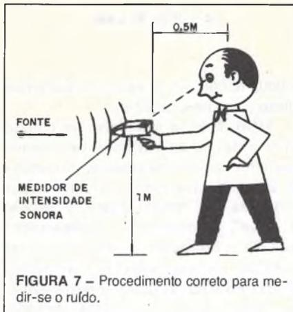
– Ao fazer a leitura, o operador deve ficar a uma distância mínima de 0,5m do medidor; figura 7, de maneira a evitar erro no valor da medida por reflexão. Neste caso o operador pode funcionar como um escudo refletor para o sinal a ser medido.
