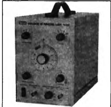
Formas de onda: senoidal, triangular, quadrada, dente de serra e pulsante. Frequência de 1 a 100kHz em 5 faixas. Saída linear ajustável de 0 a 8 volts em AC e nível DC de 4 a -4 volts. Saída TTL, distorção senoidal menor que 1% e erro de simetria menor que 1µS.
