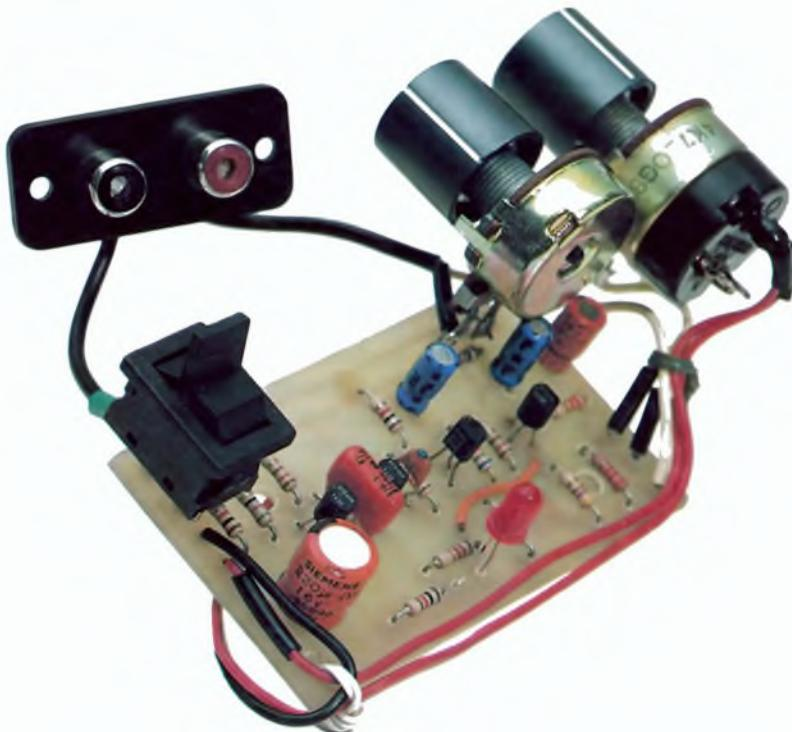
Um inversor de vídeo, conforme o nome diz, inverte o sinal de vídeo de uma câmera ou de um gravador cassette de modo a apresentar a imagem num televisor ou monitor em "negativo". Evidentemente com a intercalação do aparelho entre a câmera e o vídeo, podemos gravar o sinal em negativo com um efeito muito interessante (figura 1).
