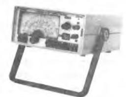
Sete escalas de freq.: A - 100 a 250 kHz, B - 250 a 650 kHz, C - 650 a 1700 kHz, D - 1, 7 a 4 MHz, E - 4 a 10 MHz, F - 10 a 30 MHz, G - 85 a 120 MHz, modulação int. e ext.
