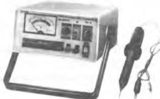
Mede FLYBACK/YOKE estático quando se tem acesso ao enrolamento. Mede FLYBACK encapsulado através de uma ponta AT. Mede capac. eletrol. no circuito e VPP.
