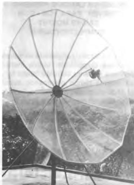
A parabólica composta por doze pétalas, é toda em alumínio, material que a torna mais leve e a isenta de ferrugens. Também acompanha poste de 1,5 m por três polegadas, com tripé de ferro ou poste liso de dois metros por 3 polegadas. O peso total é de 32 quilos e o acabamento em duas versões: aluminizada e em grafite. Sua montagem é simples e rápida, seguindo os moldes das melhores do mercado internacional.
