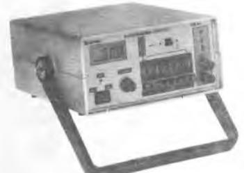
É um instrumento bastante preciso, prático, de excelente confiabilidade em suas medições em capacitores de 0,1 pF até 20.000 mF, cristal líquido, precisão de 0,5%, possui 8 escalas de medição.
