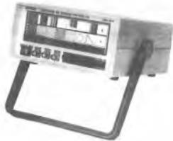
Gera padrões xadrez, verm., horiz., quadrículas, pontos, R-Y B-Y, escala de cinza, branco, fase, círculo, 8 barras cores cortadas, cores completas, Pal-NTSC puros c/ cristal, saída RF 2-3-4.
