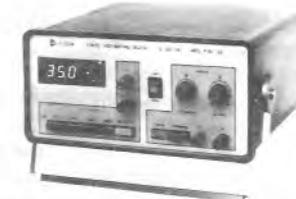
Fonte digital continuamente variável de 0 a 35 V, corrente máx. de saída 2 A, proteção sobrecarga. Voltímetro eletrônico de 0,1-1000VDC c/ impedância ent. 10 M $\Omega$ , precisão de 1%.
