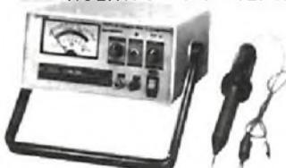
Mede FLYBACK/YOKE estático quando se tem acesso ao en-rolamento. Mede FLYBACK encapsulado através de uma ponta MAT. Mede capacitores eletrolíticos no circuito e VPP.
