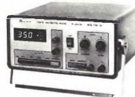
Fonte digital continuamente variável de 0 a 35 V, corrente máx. de saída 2 A, proteção sobrecarga. Voltímetro eletrônico de 0,1-1000 Vc.c. c/ impedância de entrada 10 M $\Omega$ , precisão de 1%.
