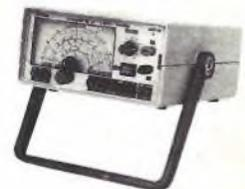
Sete escalas de frequências: A - 100 a 250 kHz, B - 250 a 650 kHz, C - 650 a 1700 kHz, D-1, 7 a 4 MHz, E - 4 a 10 MHz, F - 10 a 30 MHz, G - 85 a 120 MHz, modulação interna e externa.
