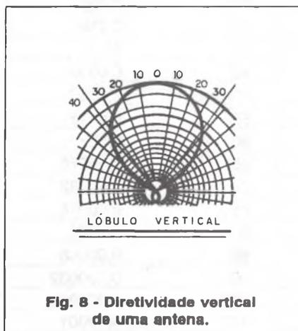
Fig. 8 - Diretividade vertical de uma antena.
