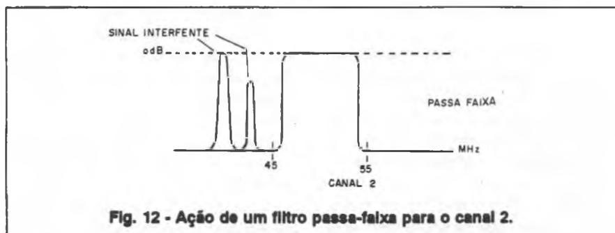
Fig. 12 - Ação de um filtro passa-faixa para o canal 2.
