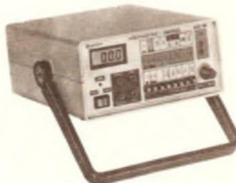
Tensão c.c. 1000 V - precisão 1%, tensão c.a. - 750 V, resistores 20 M $\Omega$ . Corrente c.c./c.a. - 20 A ganho de transistores hfe, diodos. Ajuste de zero externo para medir com alta precisão valores abaixo de 20  $\Omega$ . CR\$ 59.400,00
