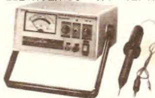
Mede FLYBACK/YOKE estático quando se tem acesso ao en-rolamento. Mede FLYBACK encapsulado através de uma ponta MAT. Mede capacitores eletrolíticos no circuito e VPP. CR\$ 76.800,00
