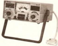
Permite verificar a emissão de cada canhão do cinescópico em prova e reativá-lo, possui galvanômetro com precisão de 1% e mede MAT até 30 KV. CR\$ 84.850,00
