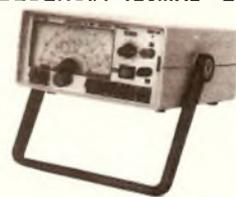
Sete escalas de freqüências: A -100 a 250 kHz, B - 250 a 650 kHz, C - 650 a 1700 kHz, D-1, 7 a 4 MHz, E - 4 a 10 MHz, F - 10 a 30 MHz, G - 85 a 120 MHz, modulação interna e externa. CR\$ 91.000,00
