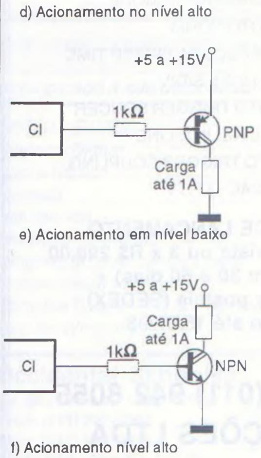
Fig. 15 - Modos de acionamento de cargas externas.
