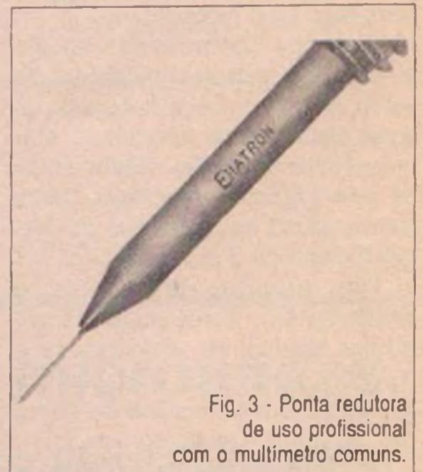
Fig. 3 - Ponta redutora de uso profissional com o multímetro comuns.
