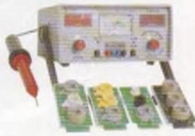
Permite verificar a emissão de cada canhão do cinescópio em prova e reativá-lo, possui galvanômetro com precisão de 1% e mede MAT até 30 kV Acompanha ponta de prova + 4 placas (12 soquetes).
