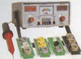
É utilizado para medir a emissão e reativar cinescópios, galvanômetro de dupla ação. Tem uma escala de 30 KV para se medir AT. Acompanha ponta de prova + 4 placas (12 soquetes).
