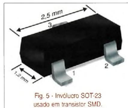
Fig. 5 - Invólucro SOT-23 usado em transistor SMD.
