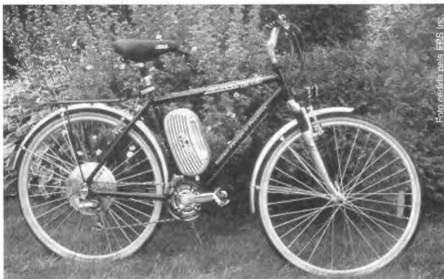
Fig. 5 - A bicicleta de turismo com assistência de energia da EPS Inc. proporciona uma autonomia de 25 a 50 km com uma carga.
