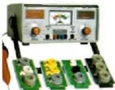
É utilizado para medir a emissão e reativar cinescópios, galvanômetro de dupla ação. Tem uma escala de 30 KV para se medir AT. Acompanha ponta de prova + 4 placas (12 soquetes).
