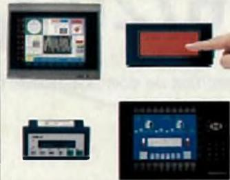
Diversos modelos de Interfaces Homem-Máquina. Possuem comunicação com diversas marcas de CLPs. Modelos com teclado de membrana ou touch-screen até 12 polegadas.
