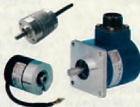
Disponíveis em modelos incrementais ou absolutos. Incrementais desde 2 até 10.000 pulsos por revolução. Saídas NPN, PNP, Push-Pull e Line Drive. Os absolutos podem ter até 13 bits em código Gray e 16 bits em BCD.
