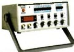
Ótima estabilidade e precisão, pode gerar formas de onda: senoidal, quadrada, triangular, faixas de 0.2 Hz a 2 MHz. Saídas VCF, TTL/MOS, atenuação 20 dB.
