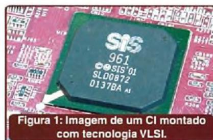
Figura 1: Imagem de um CI montado com tecnologia VLSI.
