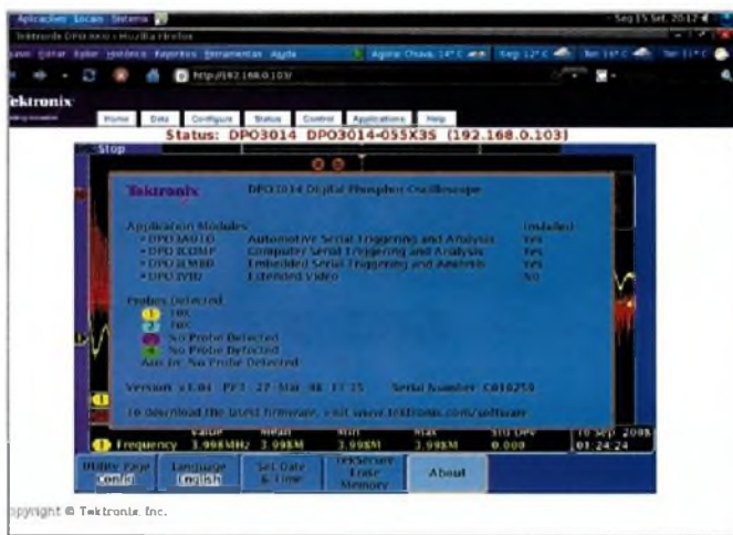
F6. Condições do DPO3014 exibidas em uma página web na rede interna (computador utilizando SO Linux)
