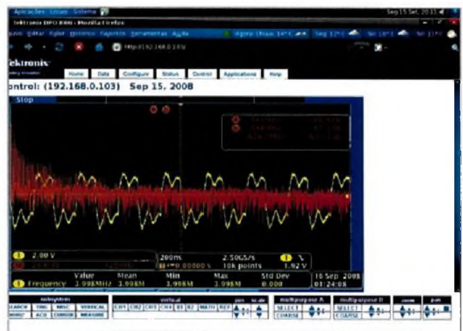
F7. interface web permite controlar as funções de um DPO3014 remotamente, independente de localização, sistema operacional e navegador utilizado
