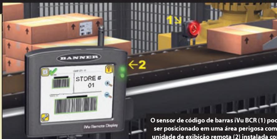
O sensor de código de barras iVu BCR (1) pode ser posicionado em uma área perigosa com a unidade de exibição remota (2) instalada com segurança ao lado de outros controles.
