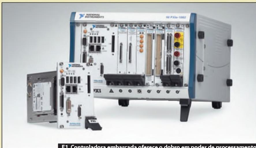
**F1. Controladora embarcada oferece o dobro em poder de processamento e em taxa de transferência de dados comparados aos modelos anteriores.**
