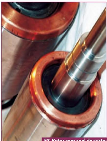
F8. Rotor com anel de curto-circuito de cobre.
