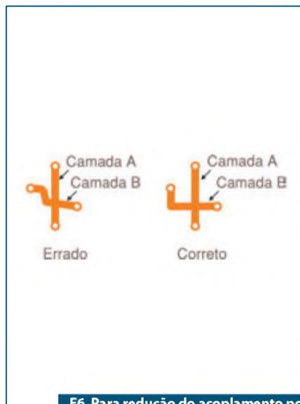
F6. Para redução do acoplamento por capacitância ou indutância.
