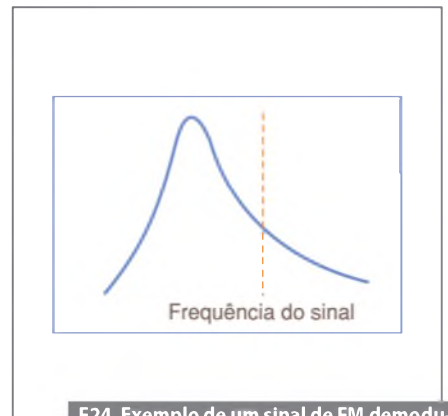
F24. Exemplo de um sinal de FM demodulado na tela do Analisador de Espectro.
