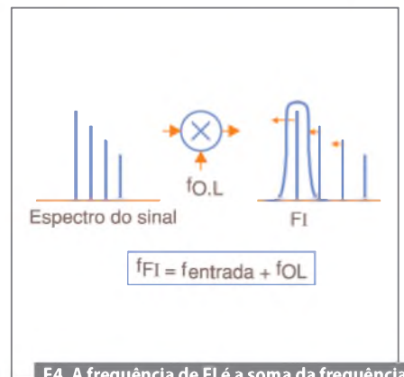
F4. A frequência de FI é a soma da frequência do sinal entrada com a do oscilador local.
