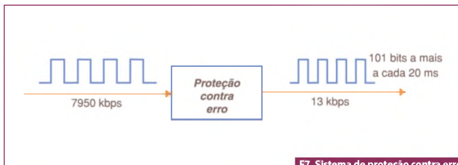
F7. Sistema de proteção contra erros usando redundância cíclica.
