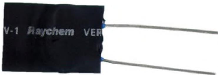
F27. "Espaguete" termo-retrátil como proteção para evitar estilhaços, no caso de explosão do varistor.
