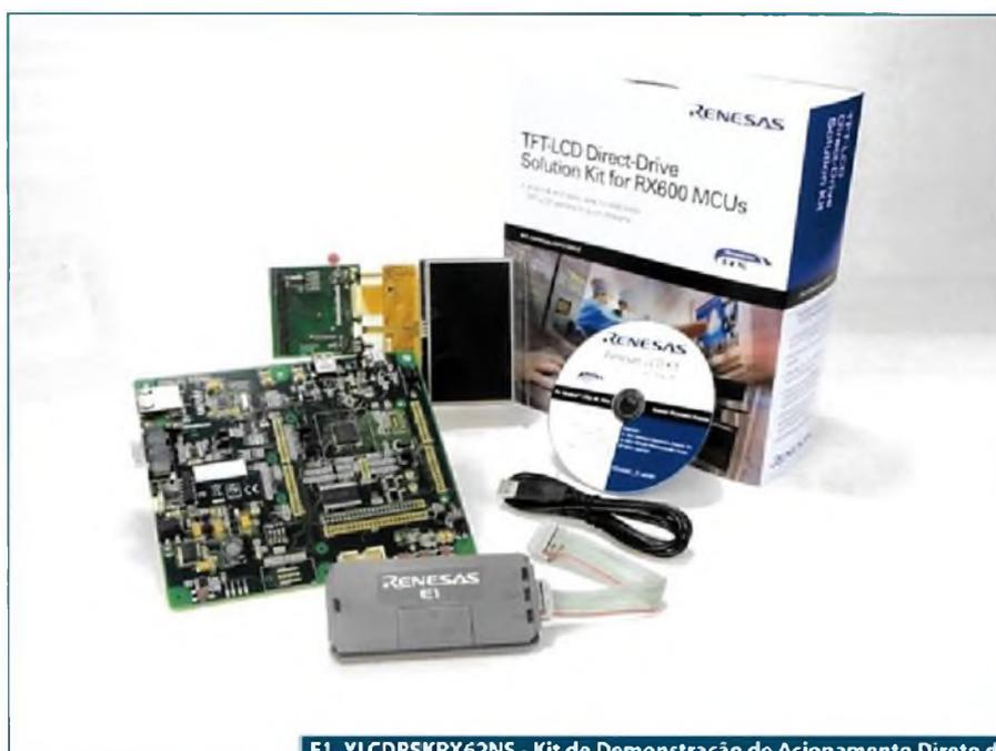
F1. YLCDRSKRX62NS - Kit de Demonstração de Acionamento Direto do LCD-TFT com RX62N (RX62N TFT-LCD Direct-Drive Demo Kit).
