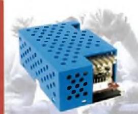
e PoE, a família GTM91110P240 de fontes de alimentação ca/cp de estrutura aberta da GlobTek fornece até 240 W de potência, ocupando espaço de 3 x 5 polegadas. Os dispositivos são fornecidos configurados em fábrica com saídas de 12 a 55 V (em incrementos de 0,1 V). Disponíveis em versões Classe I ou II, as fontes de alimentação de 1,75 polegada de altura apresentam eficiência de 85% com carga plena e
