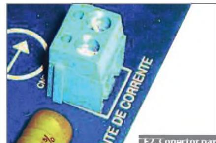
F2. Conector para conexão da carga.
