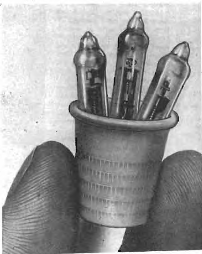
Fig. 2 — Tre DF66 possono essere contenute in un comune ditale.
