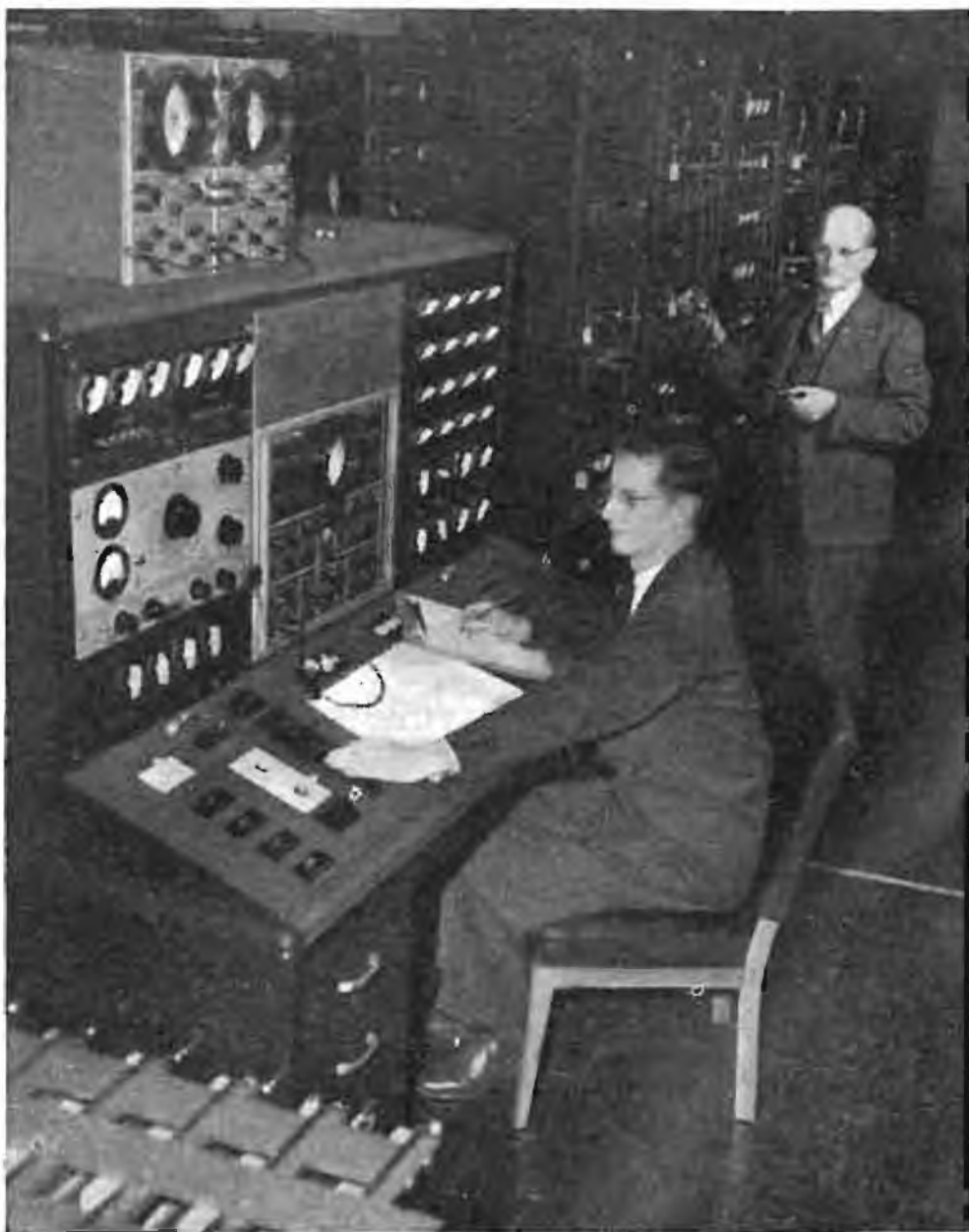
Un recente modello di calcolatrice elettronica che è stata costruita dagli studenti della Northwestern University di Evanston, Ill., U.S.A., con componenti della Westinghouse Electric Corp. La calcolatrice viene qui impiegata nel laboratorio di ricerche aeronautiche della stessa università per la soluzione delle più intricate equazioni relative al progetto di nuovi modelli di aerei.
